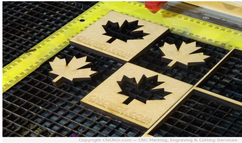
Εικόνα 4.5 Κοπή σε ξύλο 6mm
