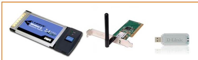
Εικόνα 5: Ασύρματες κάρτες δικτύου με διάφορες συνδεσμολογίες (PCMCIA, PCI και USB από αριστερά προς τα δεξιά)
