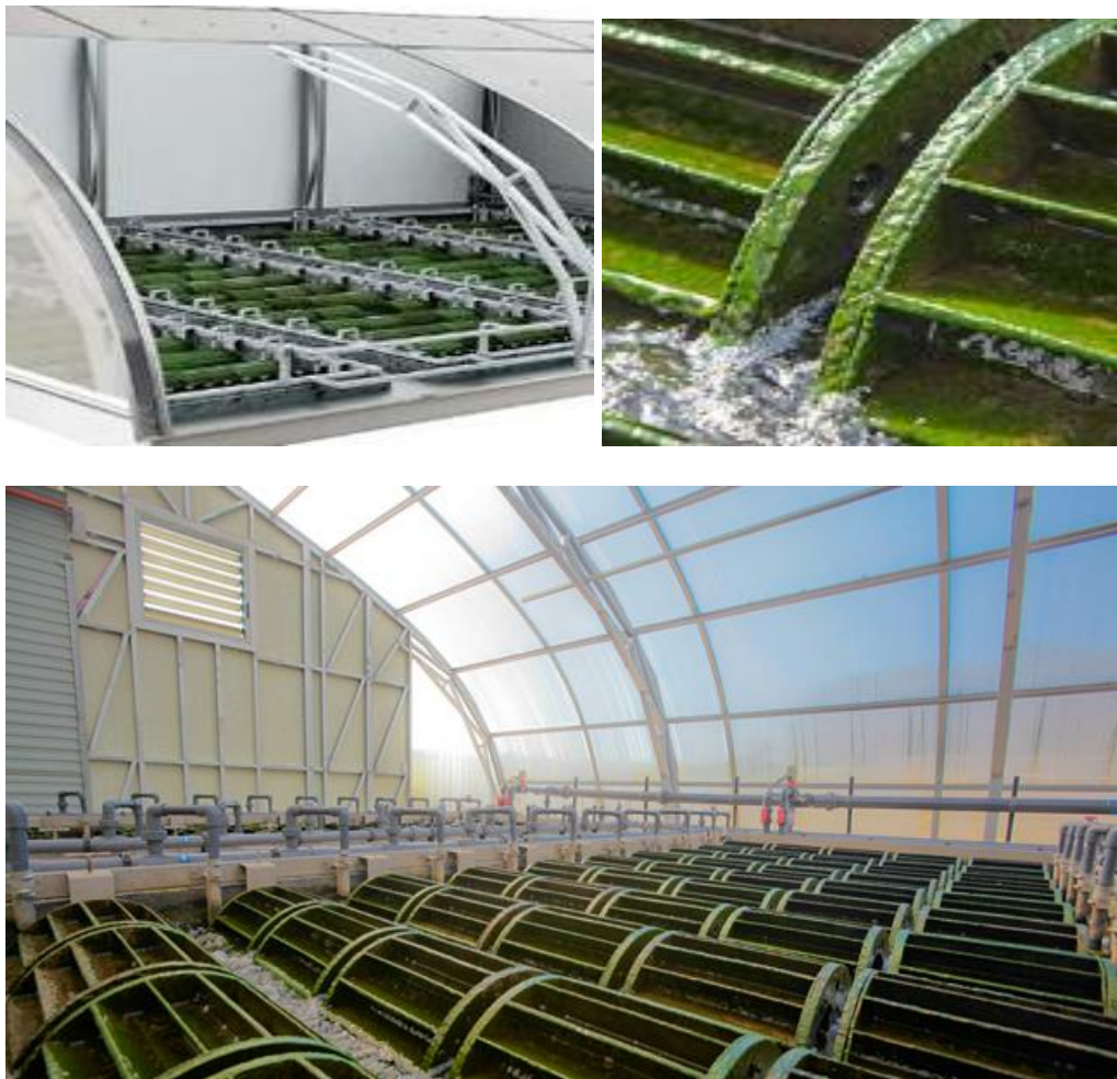
Σχήμα 15: Υβριδική τεχνολογία Ανάπτυξης Φυκών, Algaewheel
