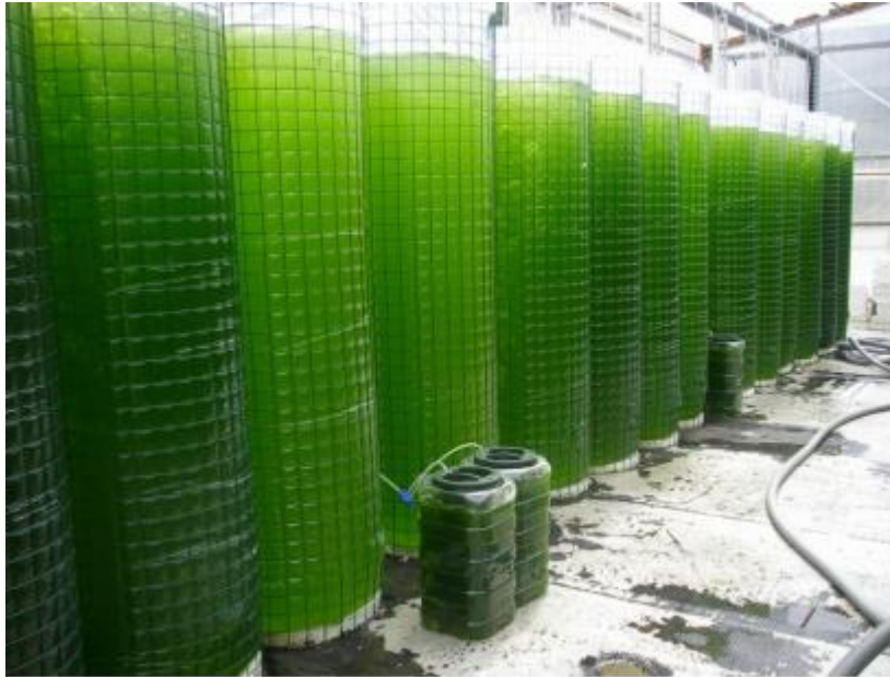
Σχήμα 12: Βιοαντιδραστήρες πολυαιθυλενίου μιας χρήσης, 300 L. Plagton S.A., Μύτικας Αιτωλοακαρνανίας
