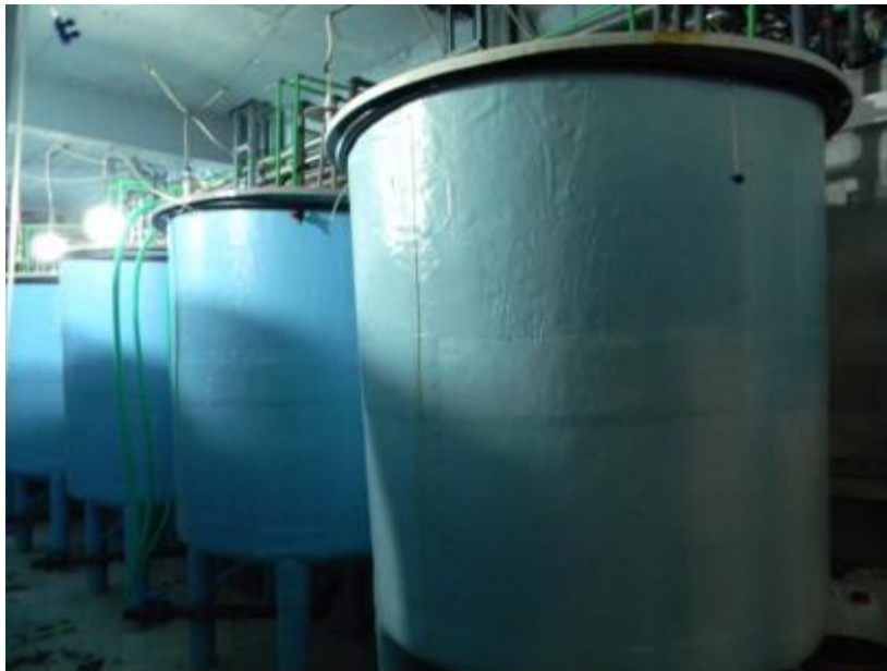
Σχήμα 13: Βιοαντιδραστήρας βιομηχανικής κλίμακας, 2,500 L. Plagton S.A, Μύτικας Αιτ/νιας
