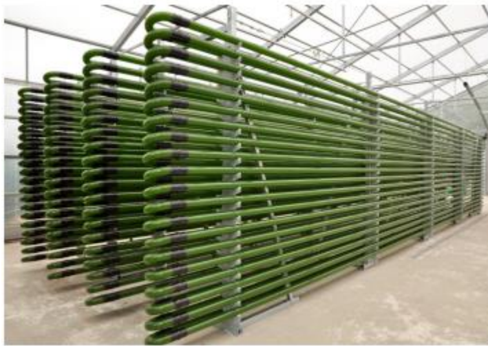
Σχήμα 11: Αυλωτός φωτοβιοαντιδραστήρας χωρητικότητας 4000 λίτρων για την παραγωγή υψηλής προστιθέμενης αξίας προϊόντων από μικροφύκη (IGV-Biotech)
