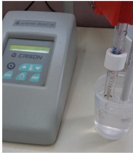
Εικόνα 11. Συσκευή εκχύλισης πάστας κορεσμού και συσκευή μέτρησης pH & EC.
