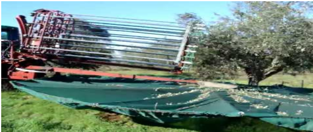
Εικόνα 4. Αυτοκινούμενο μηχάνημα ελαιοσυλλογής με περιστροφικές βέργες
