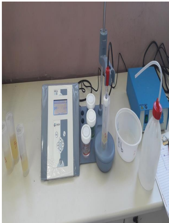
Εικόνα 12. Αριστερά συσκευή μέτρησης ηλεκτρικής αγωγιμότητας, δεξιά συσκευή μέτρησης pH.
