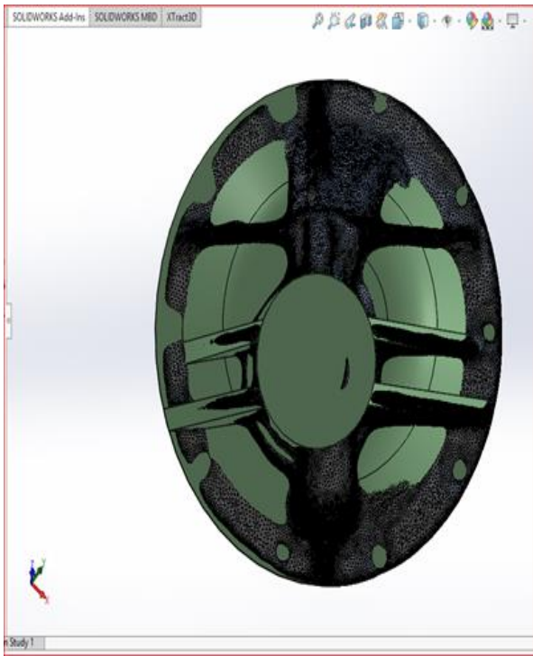
Εικόνα 225. Σύγκριση πολυγωνικού μοντέλου με το τρισδιάστατο σχέδιο.
