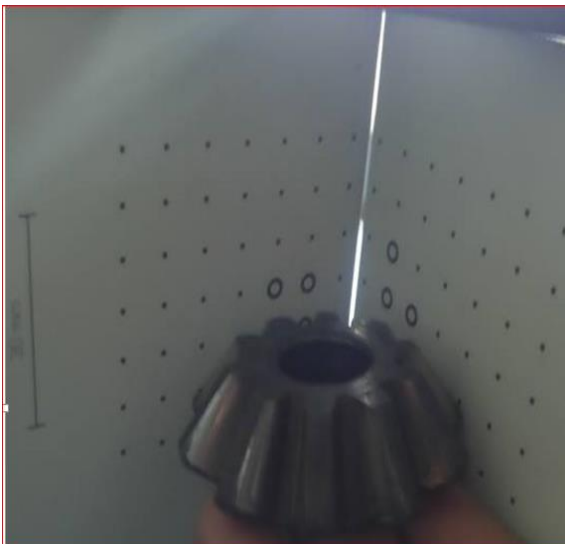
Εικόνα 11. Τοποθέτησης δορυφόρου στη σωστή κλίμακα τη πλάκας βαθμονόμησης.
