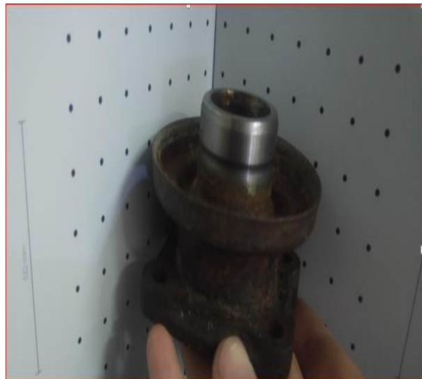
Εικόνα 12. Τοποθέτησης εξωτερικής φουσούνας στη σωστή κλίμακα της πλάκας βαθμονόμησης.
