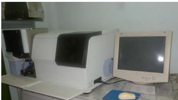
Σχήμα 9 Φασματογράφος ατομικής απορρόφησης φλόγας (AAS) Perkin Elmer Analyst 300
