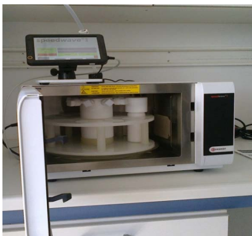
Σχήμα 7 Εσωτερικό φούρνου μικροκυμάτων Microwave Digestion System speedwave two, Berghof με κλειστά δοχεία DAP-60K
