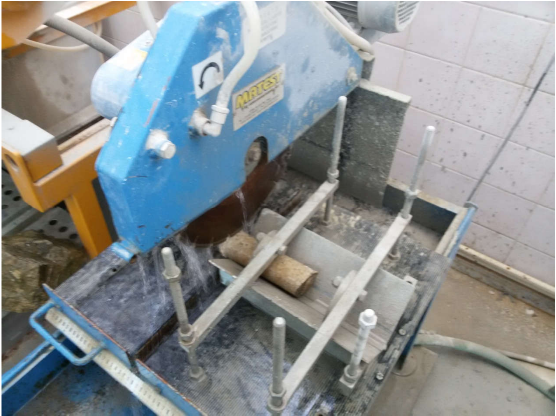
Εικόνα 7. Κοπή των δυο άκρων του πυρήνα με τη χρήση αδαμαντοτροχού για τη διαμόρφωση κυλινδρικού σχήματος .
