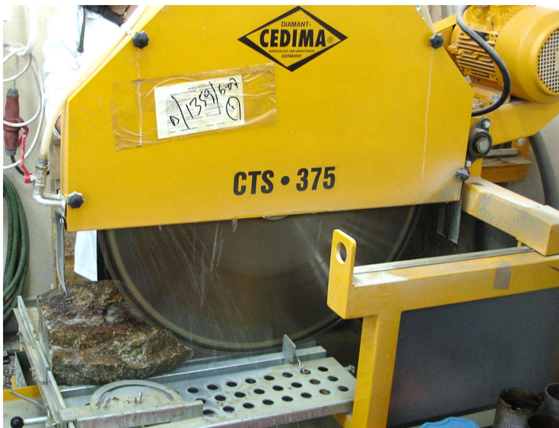
Εικόνα 6. Κοπή και διαμόρφωση δειγμάτων με την χρήση αδαμαντοτροχού.
