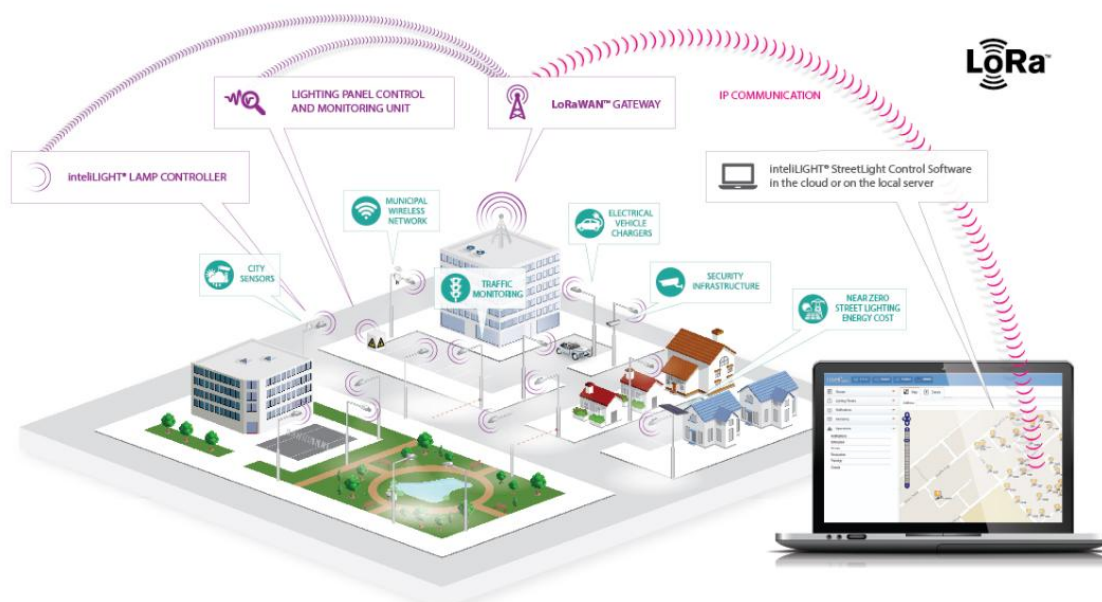
Εικόνα 27 Αρχιτεκτονική δικτύου έξυπνου συστήματος Streetlight IntelliLIGHT® [60]
