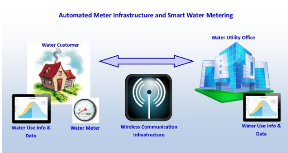
Εικόνα 26 Αρχιτεκτονική «έξυπνης» υποδομής συστήματος τηλεμέτρησης κατανάλωσης νερού[58]
