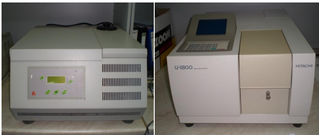
Εικόνα 37.: Μηχάνημα ψυχόμενης φυγόκεντρο του εργαστηρίου Βοτανικής ΑΤΕΙ-Θ. (Νικολαΐδης, Α.) και Εικόνα 38.: Φασματοφωτόμετρο LKB Ultraspec II του εργαστηρίου Βοτανικής ΑΤΕΙ-Θ ( Νικολαΐδης, Α.).
