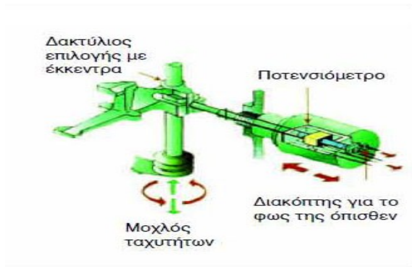
Σχήμα 17. Αισθητήρας θέσης του μοχλού ταχυτήτων.
