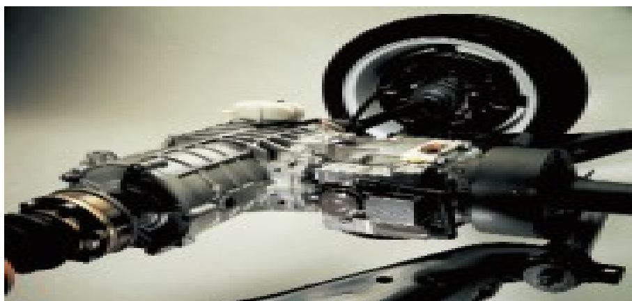
Σχήμα 28. Μορφή πίσω άξονα με σύστημα HALDEX.
