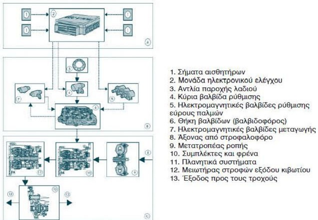
Σχήμα 26. Τυπικό διάγραμμα μιας μονάδας ηλεκτρονικού ελέγχου ενός αυτόματου κιβωτίου ταχυτήτων.
