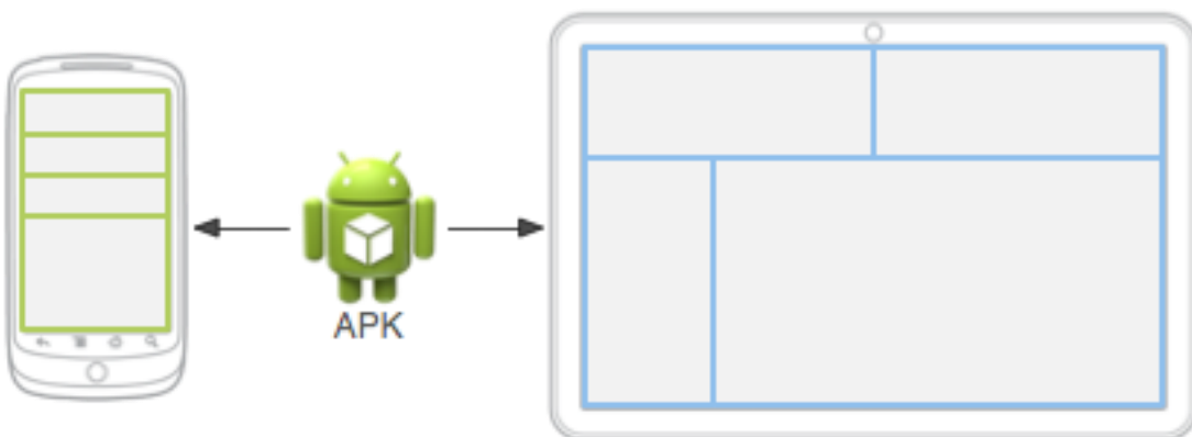
Εικόνα 6: Δυο διαφορετικές συσκευές που η καθεμία χρησιμοποιεί τους παρεχόμενους πόρους για διαφορετικές διαστάσεις οθονών
