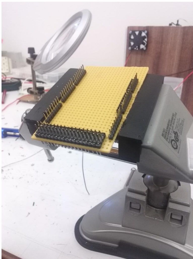
Εικόνα 6-10 - Κατασκευή αυτοσχέδιας πλακέτας για τον Arduino Mega
