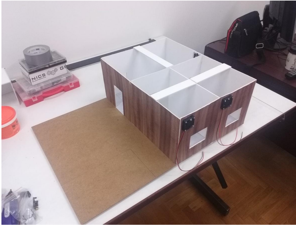
Εικόνα 6-2 - Η μακέτα με τοποθετημένους τους ανεμιστήρες σε κάθε δωμάτιο.
