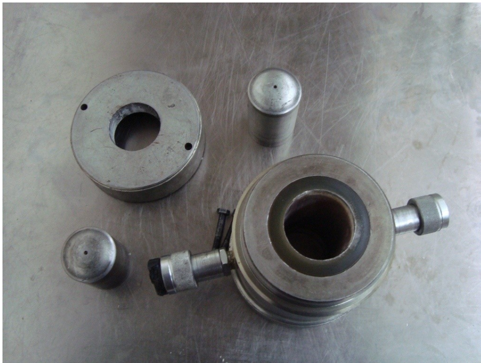
Εικόνα 4.54: Τριαξονικό κελί υψηλών πιέσεων αποσυναρμολογημένο (Hoek cell).
