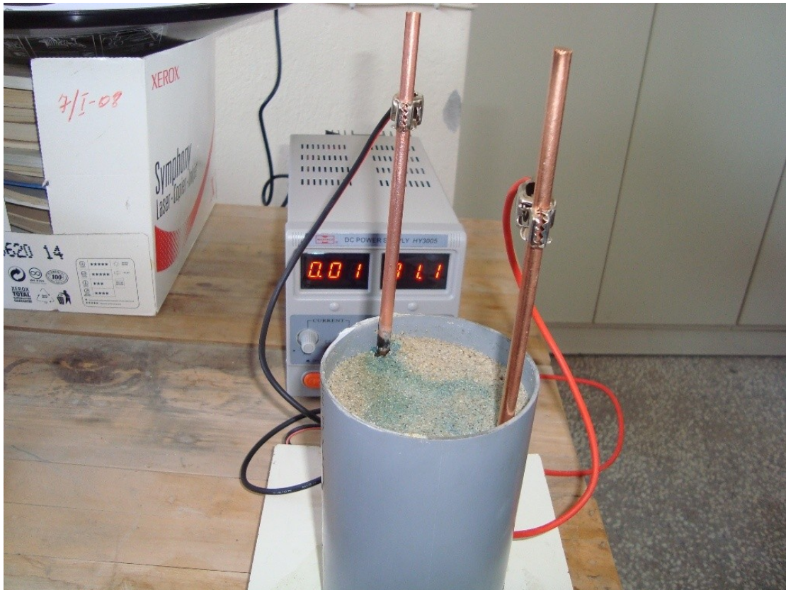
Εικόνα 6.1: Πειραματική διαδικασία ηλεκτρόλυσης του χωμάτινου δοκιμίου.
