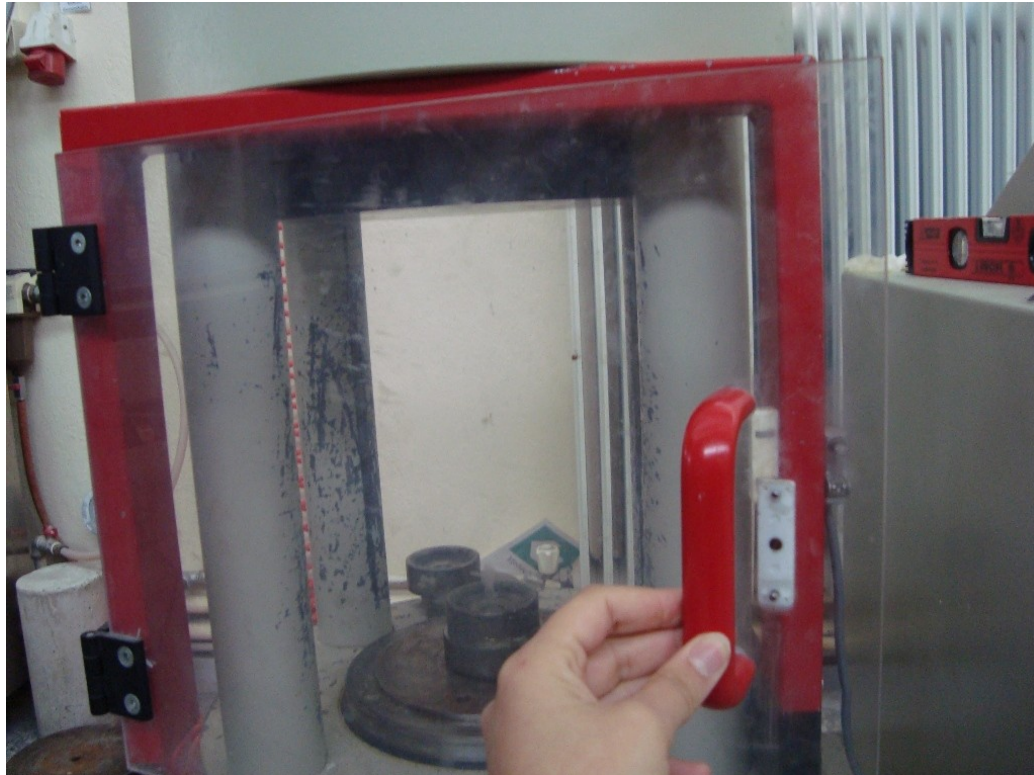
Εικόνα 4.45: Πορτάκι ασφαλείας στο μηχάνημα της πρέσας..
