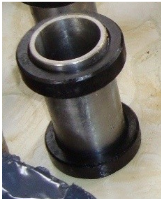
Εικόνα 4.22: Συναρμολογημένη μήτρα νέου τύπου με σταθερούς πλαστικούς σφικτήρες – δακτύλιοι.
