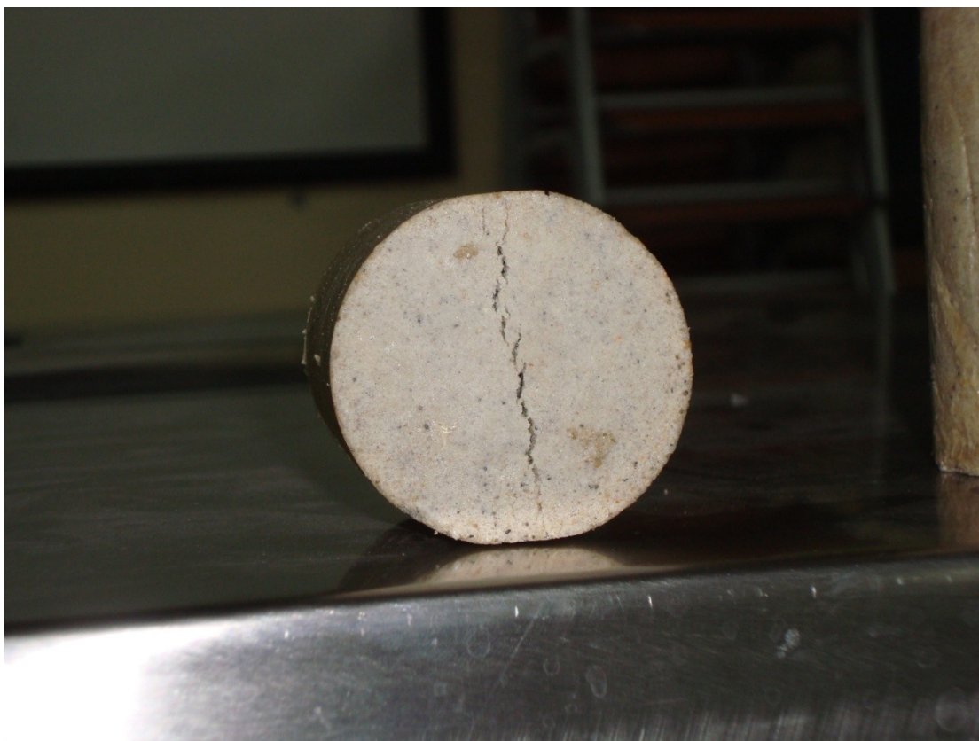
Εικόνα 5.3: Διάταξη ρωγμής δοκιμίου μετά από δοκιμή “Brazilian Test”.
