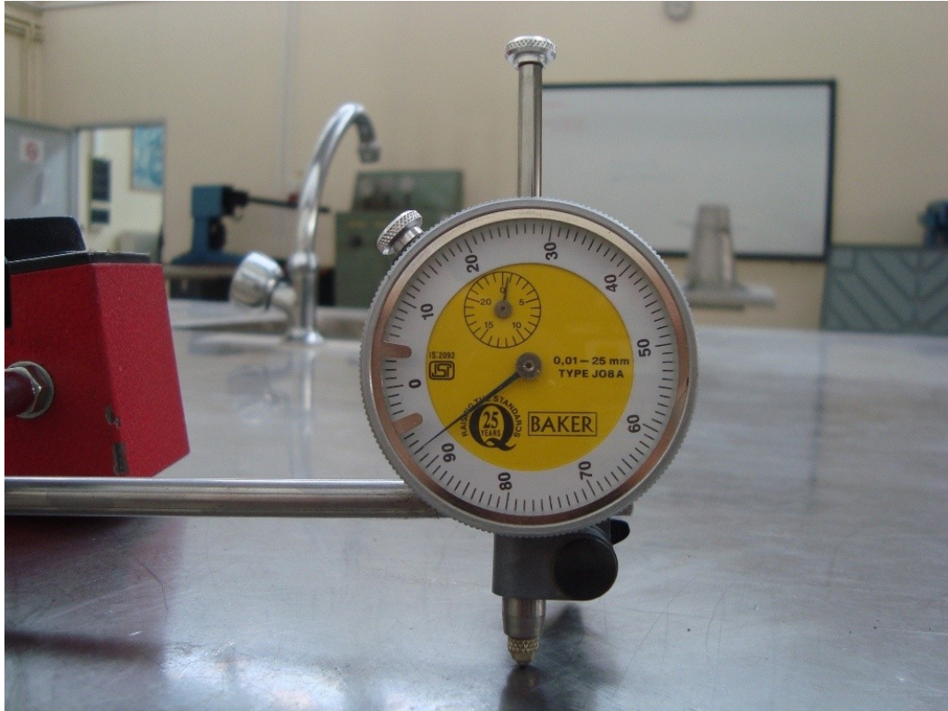
Εικόνα 4.46: Αναλογικό μηκυνσιόμετρο. Μετράει την παραμόρφωση δοκιμίου σε εκατοστά του χιλιοστού.
