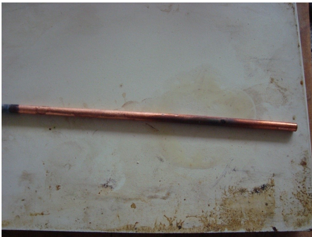
Εικόνα 6.4 : Ηλεκτρόδιο από άνθρακα με εξωτερικό περίβλημα χαλκού.
