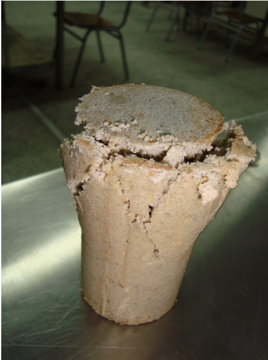
Εικόνα 5.1: Αστοχία του δοκιμίου μετά την καταπόνηση του σε δοκιμή μονοαξονικής θλίψης.
