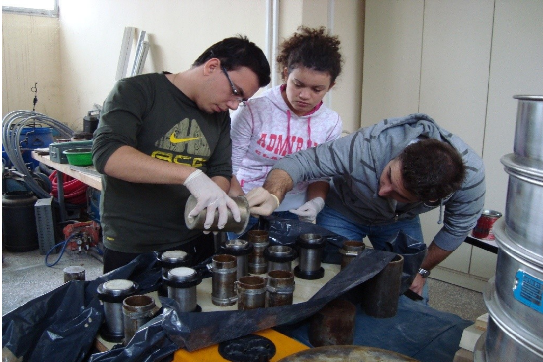
Εικόνα 4.24: Αφαίρεση του μίγματος από τον πυθμένα με τη βοήθεια σπάτουλας.
