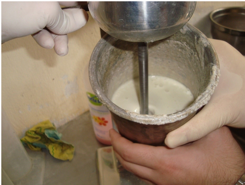
Εικόνα 4.17: Ανάδευση εποξειδικής ρητίνης, σκληρυντή και πόσιμου νερού σε μεταλλικό δοχείο με κατάλληλο μηχανήμα ανάδευσης.
