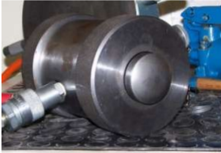
Εικόνα 4.55: Συναρμολογημένο τριαξονικό κελί υψηλών πιέσεων (Hoek cell).
