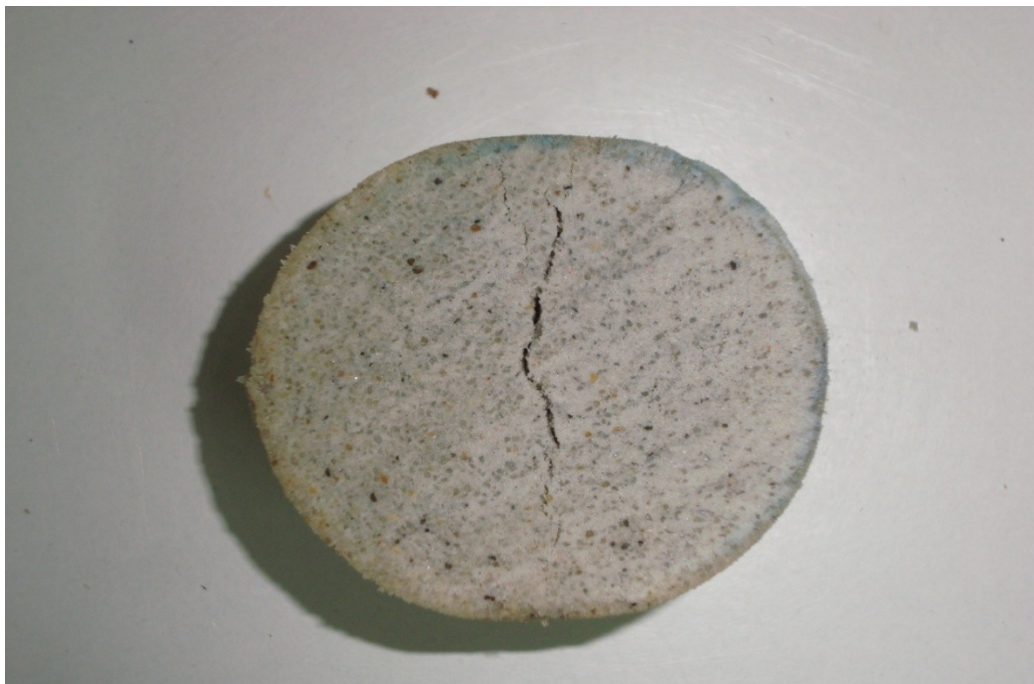
Εικόνα 5.2: Ρωγμή σε δοκίμιο μετά από δοκιμή έμμεσου εφελκυσμού.
