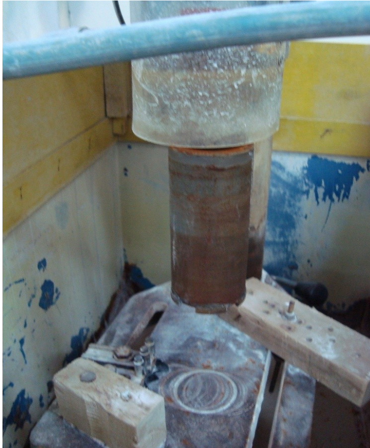
Εικόνα 6.7 : Διατρητικό μηχάνημα συλλογής δοκιμίων διαμέτρου 5.43 cm με δυνατότητα διαβροχής νερού.
