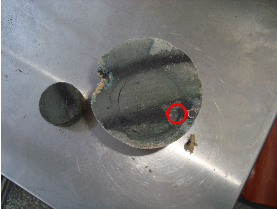
Εικόνα 6.5: Μίγμα μετά το πέρας του χρόνου σκλήρυνσης του, όπου φαίνεται καθαρά το ηλεκτρόδιο μέσα στο μίγμα (μέσα σε κόκκινο κύκλο).
