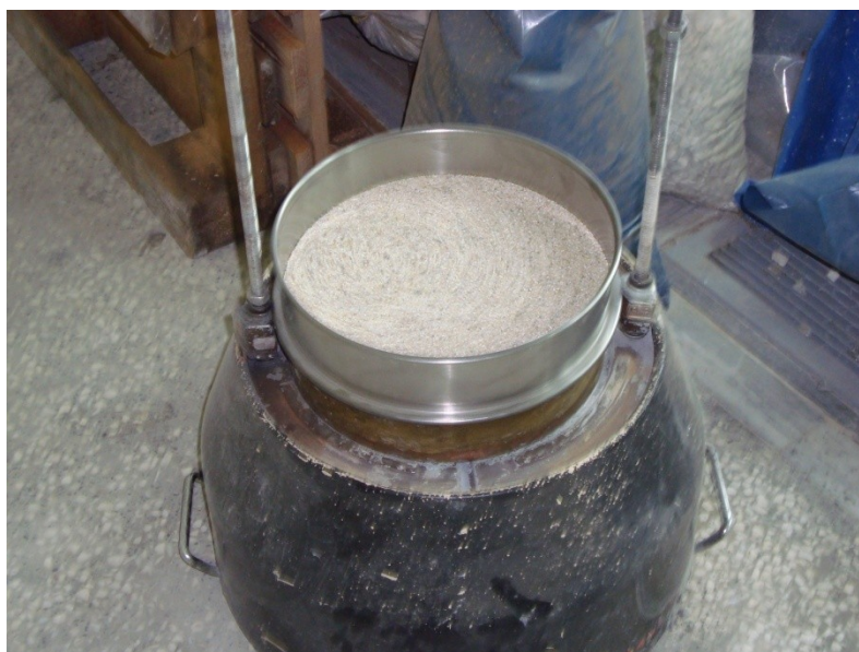
Εικόνα 4.8: Κοσκίνισμα της Γαλλικής άμμου σε κόσκινο Νο 20.
