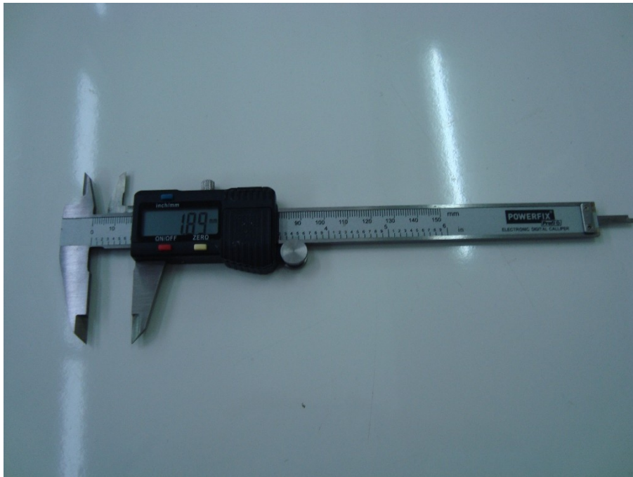
Εικόνα 4.48: Ηλεκτρονικό παχύμετρο ακριβείας \pm 0.01\text{mm} .
