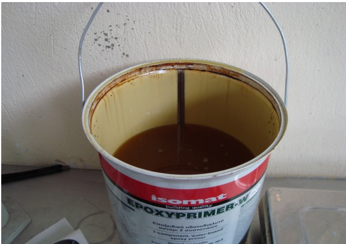
Εικόνα 4.2: Εμπορική συσκευασία υδατοδιαλυτής εποξειδικής ρητίνης (Συστατικό Α) Epoxyprimer-W της εταιρείας ISOMAT .
