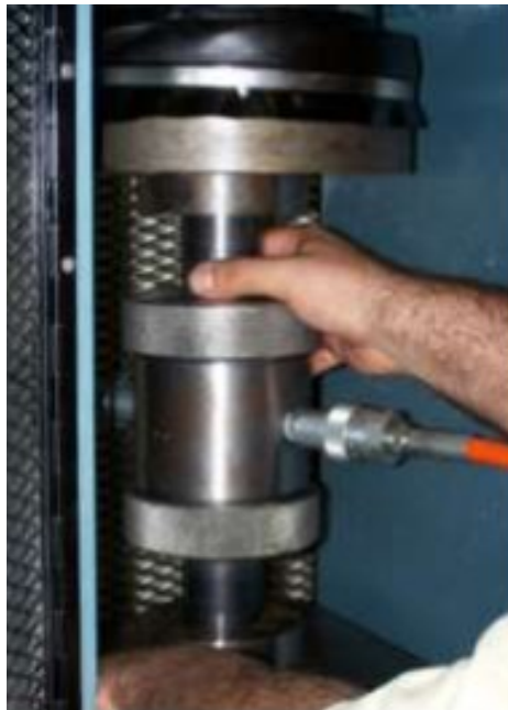
Εικόνα 4.59: Διαδικασία σταθεροποίησης του κελιού τριαξονικής δοκιμής.
