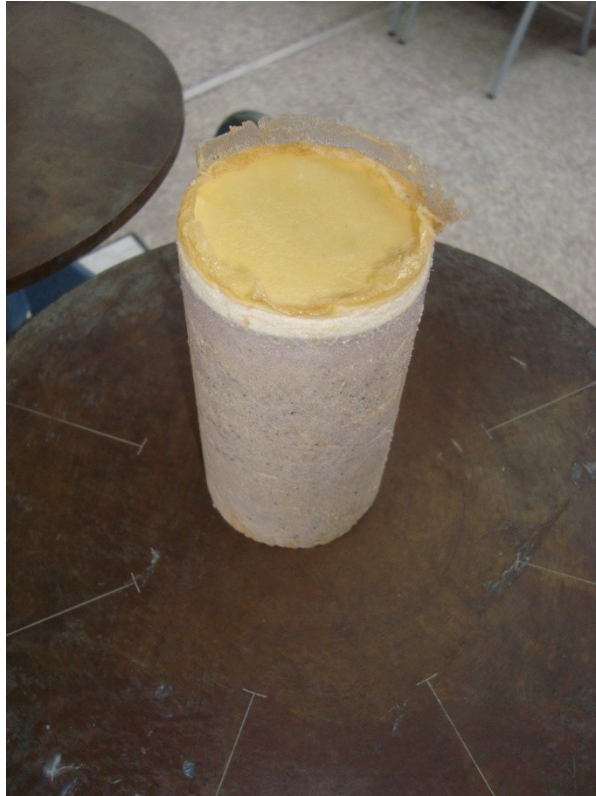
Εικόνα 4.30: Δοκίμιο μετά την αποκόλληση του από την μήτρα.
