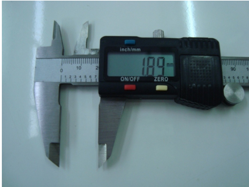
Εικόνα 4.42: Ηλεκτρονικό παχύμετρο ακριβείας \pm 0.01 mm.
