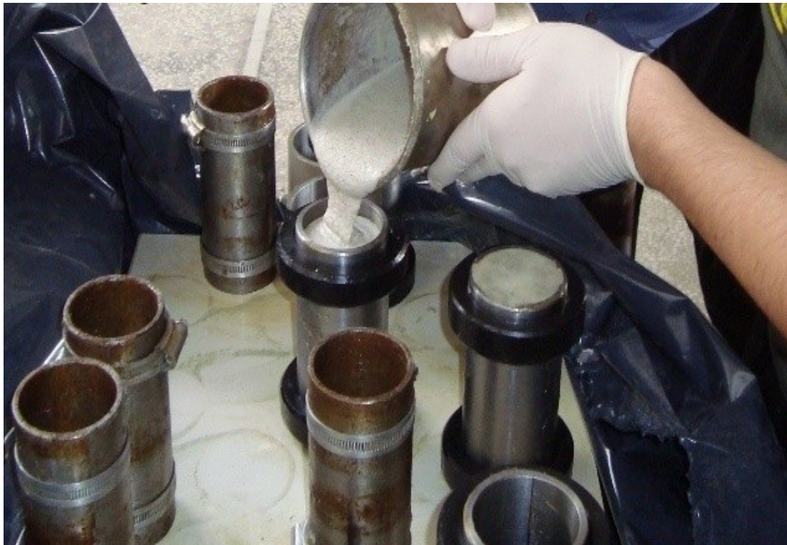
Εικόνα 4.23: Ρήξη του τελικού μίγματος στις συναρμολογημένες μήτρες.
