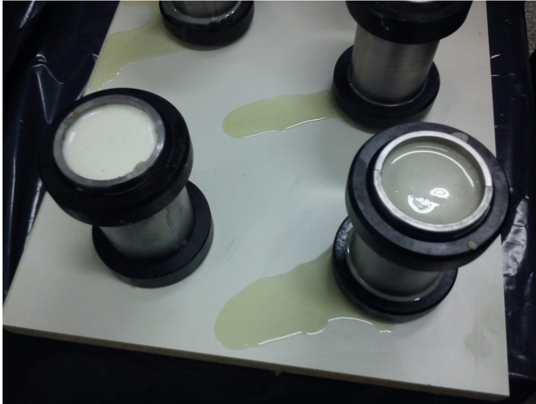
Εικόνα 4.27: Φαινόμενο διαρροής υγρού κατά τη διάρκεια σκλήρυνσης του μίγματος.
