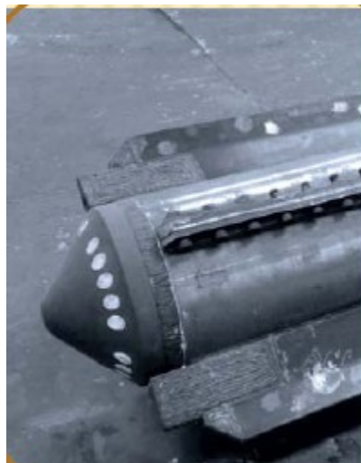
Εικόνα 2.8: Διάταξη Δυναμικής Συμπύκνωσης
