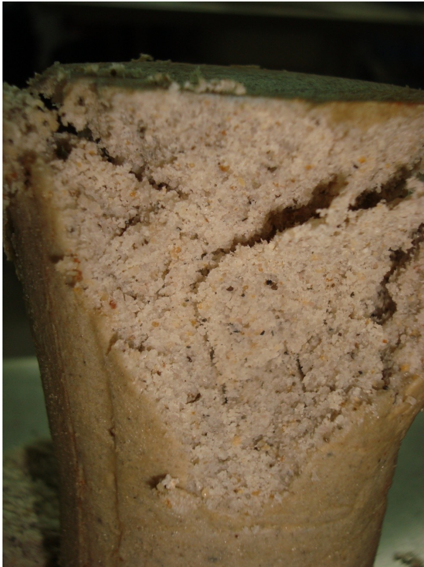
Εικόνα 5.2: Αστοχία του δοκιμίου που προκλήθηκε έπειτα από δοκιμή μονοαξονικής θλίψης.
