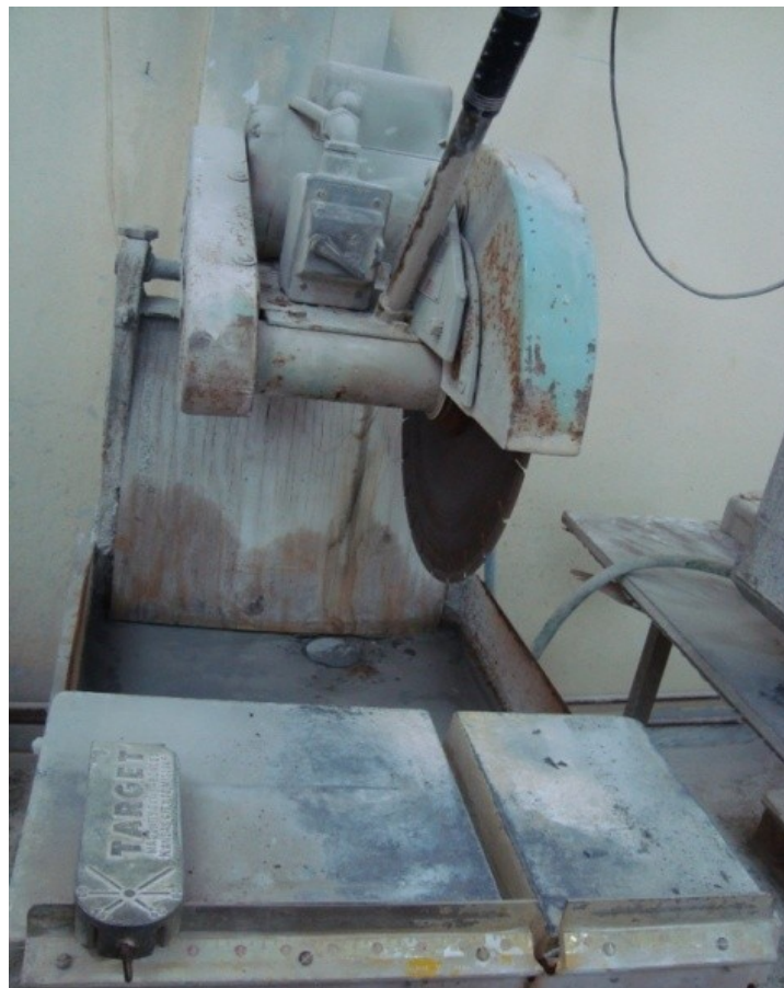
Εικόνα 4.47: Συνολική διάταξη μηχανήματος κοπής δοκιμίων, αποτελούμενη από τον τροχό και τη βάση τοποθέτησης δοκιμίων.
