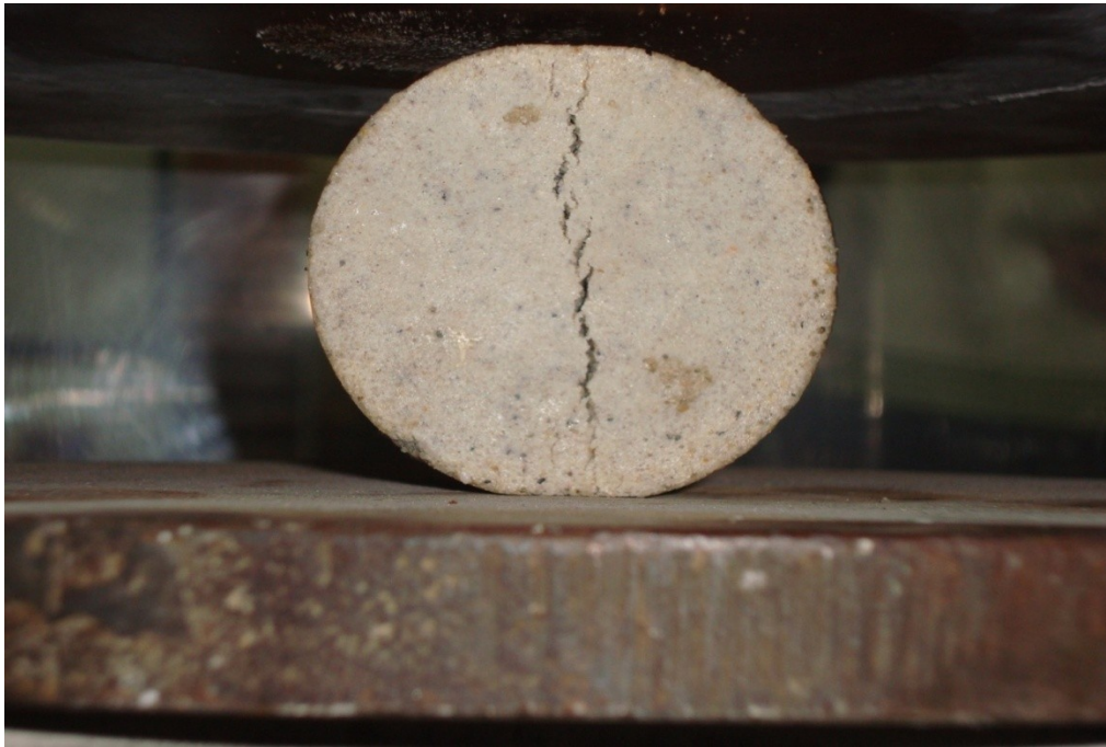
Εικόνα 5.1: Θραύση δοκιμίου μετά από δοκιμή κατά γενέτειρα.
