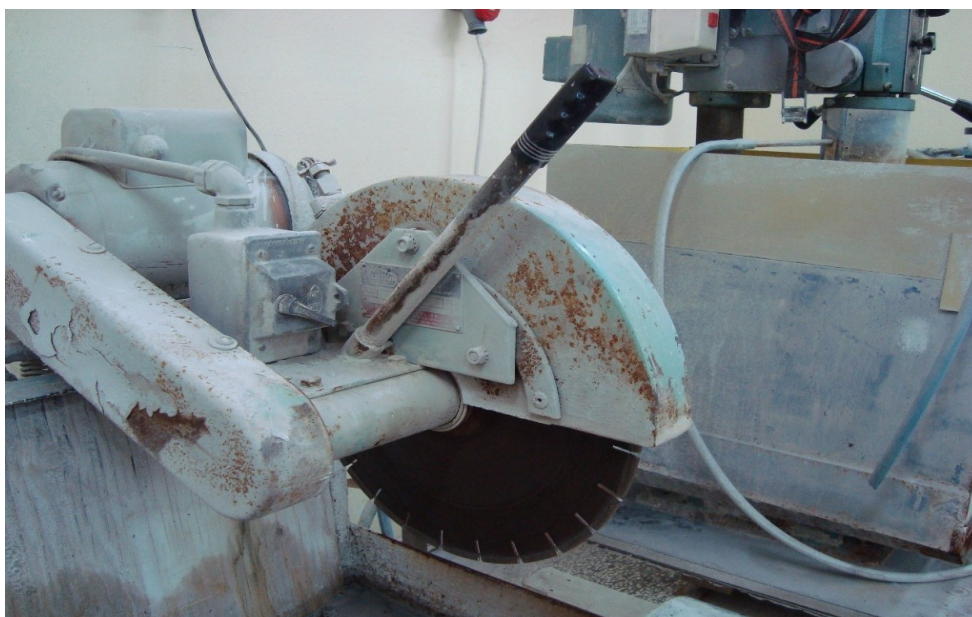
Εικόνα 4.41: Μηχάνημα κοπής και λείανσης δοκιμίων
