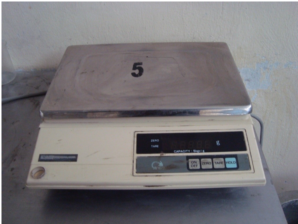
Εικόνα 4.6: Ζυγαριά ακρίβειας 0.1γρ.
