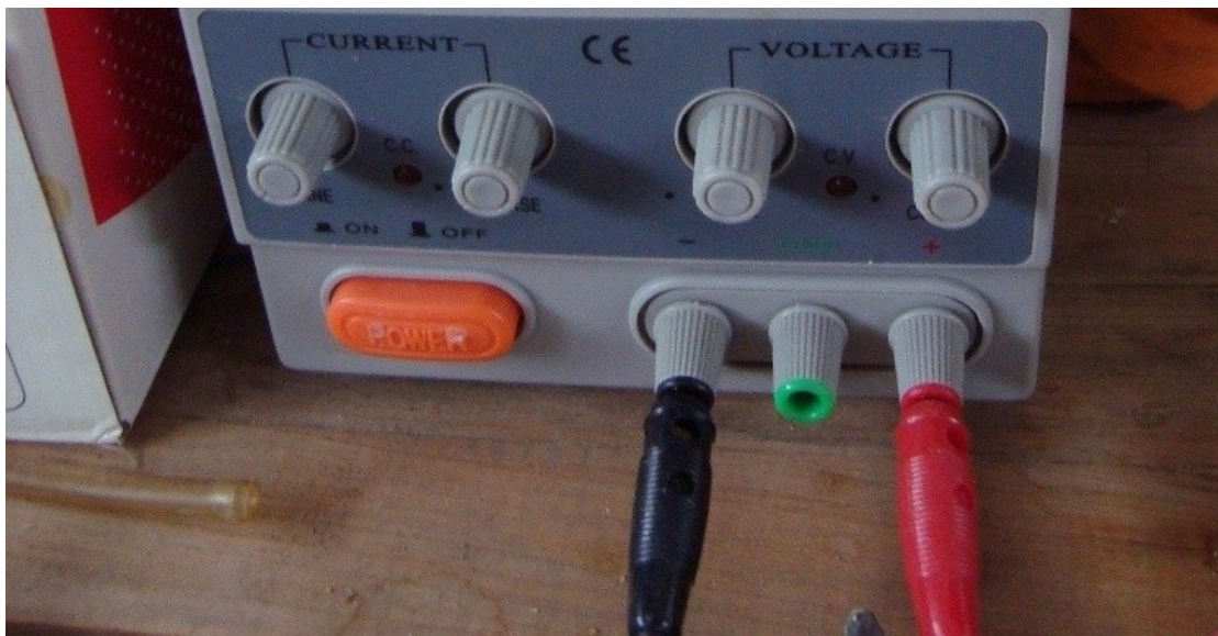
Εικόνα 6.3: Διάταξη βυσμάτων και καλωδίων στη συσκευή ηλεκτρόλυσης.
