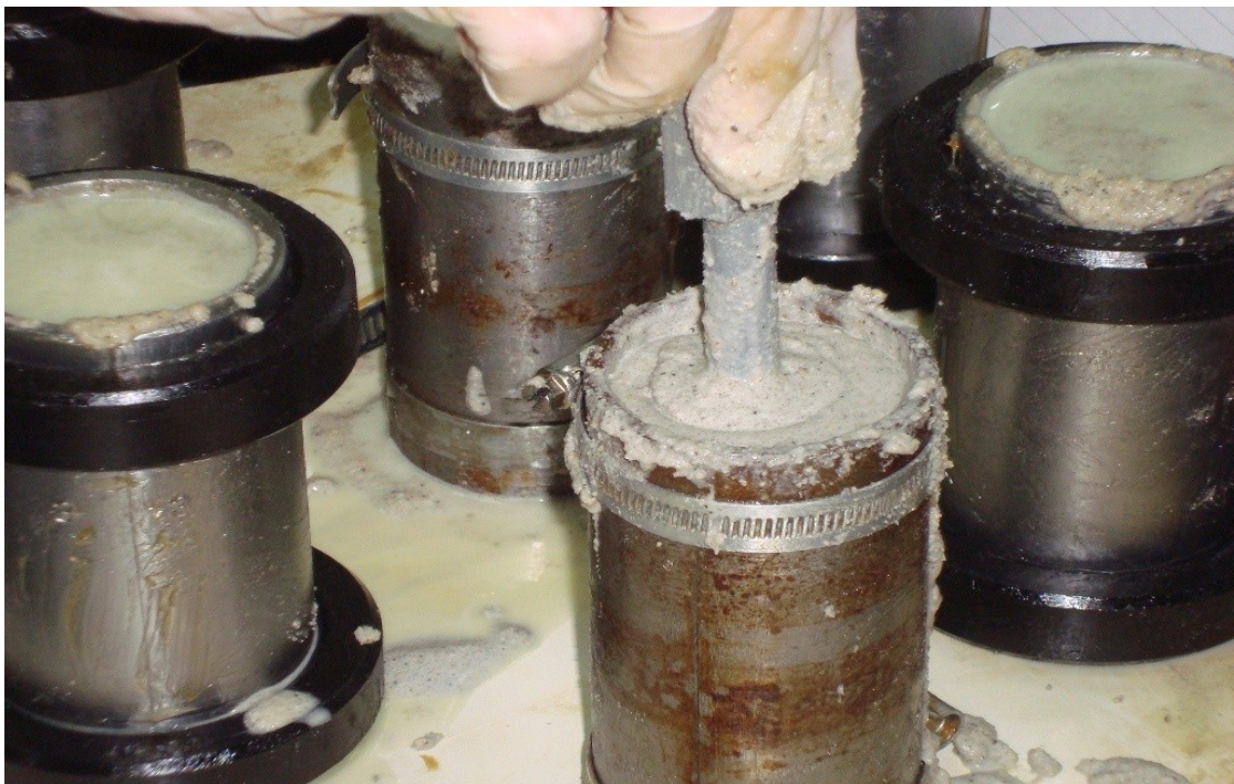
Εικόνα 4.25: Συμπύκνωση του μίγματος με κατάλληλη πλαστική ράβδο για ομογενοποίηση του υλικού.
