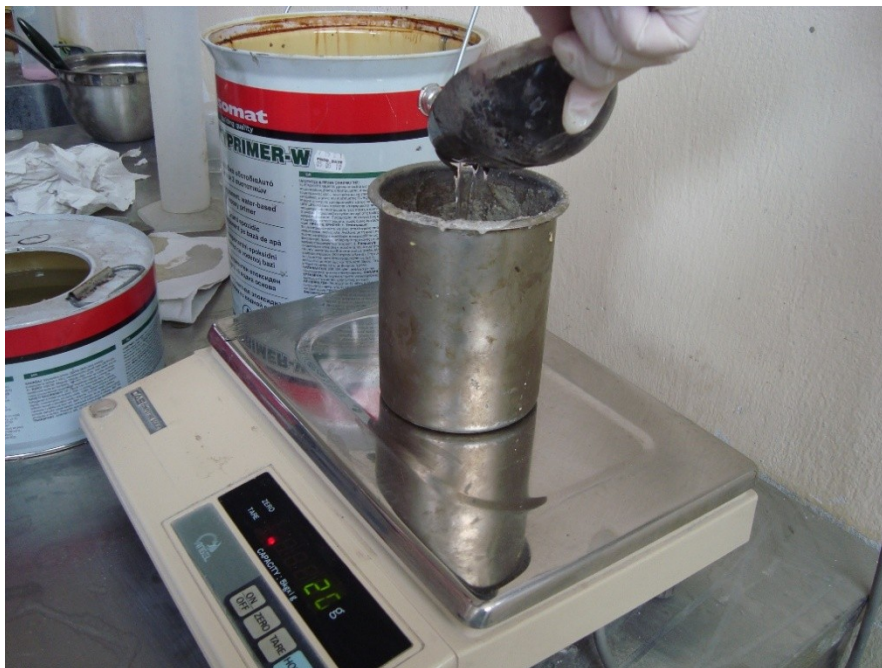
Εικόνα 4.14: Ρήξη σκληρυντή (Συστατικό Β) σε μεταλλικό δοχείο και ζύγισή του σε ζυγαριά ακριβείας.
