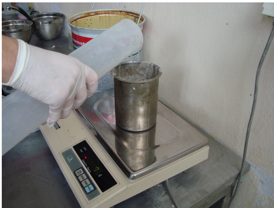
Εικόνα 4.15: Ρήψη πόσιμου νερού από ογκομετρικό κύλινδρο σε μεταλλικό δοχείο και ζύγιση του σε ζυγαριά ακριβείας.
