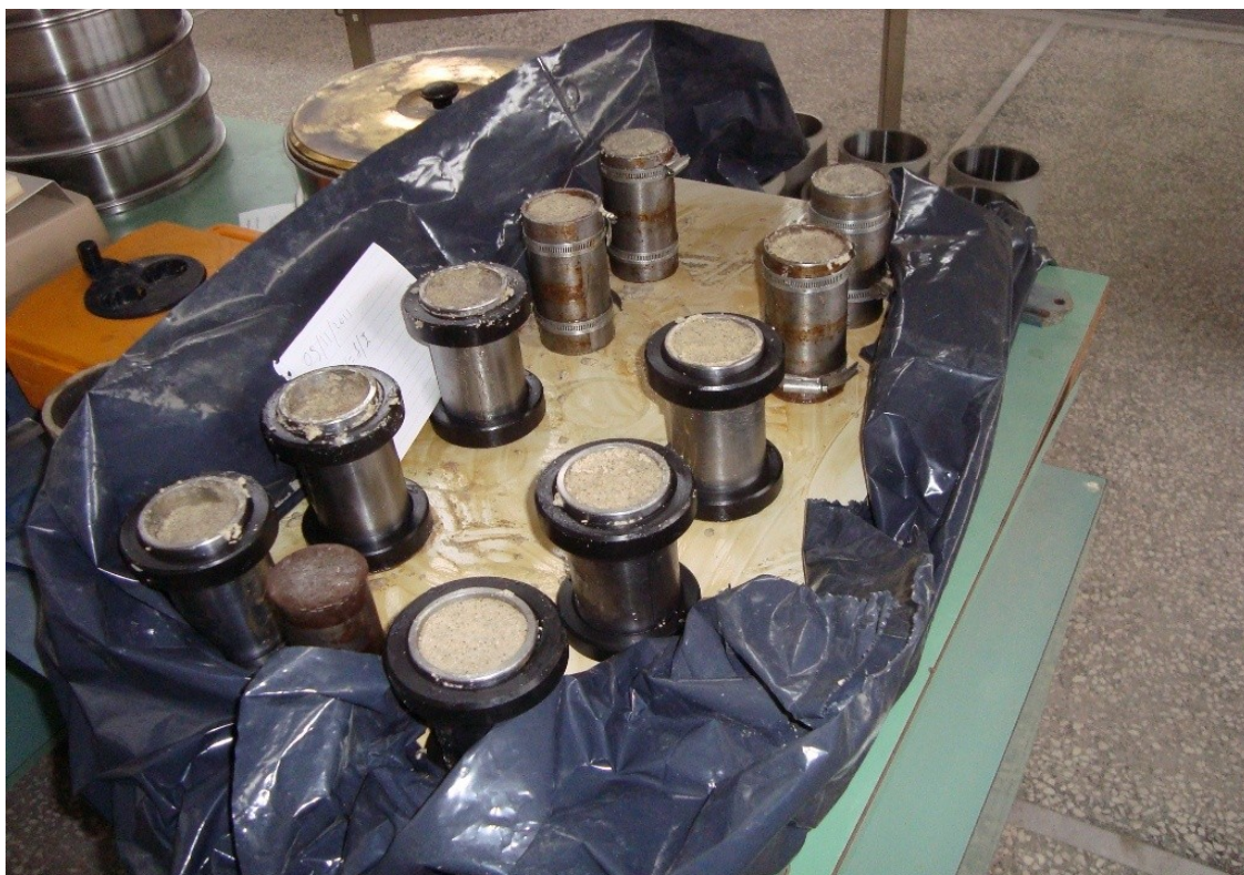
Εικόνα 4.28: Δοκίμια εντός των μητρών κατά τη διάρκεια σκλήρυνσης τους.
