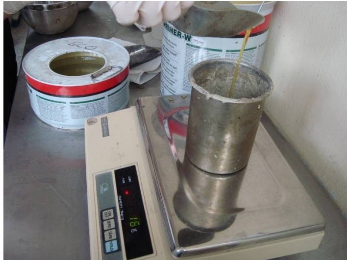
Εικόνα 4.13: Ρήξη εποξειδικής ρητίνης (Συστατικό Α) σε μεταλλικό δοχείο και ζύγιση της σε ζυγαριά ακριβείας.
