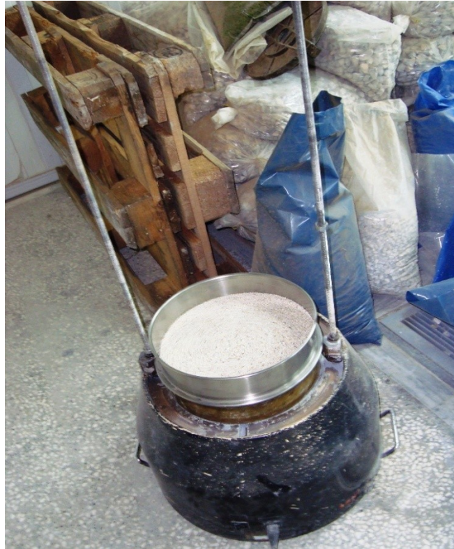
Εικόνα 4.9: Κόσκινο τοποθετημένο σε μηχανήμα κοσκινίσματος το οποίο λειτουργεί με δόνηση (δονητής).
