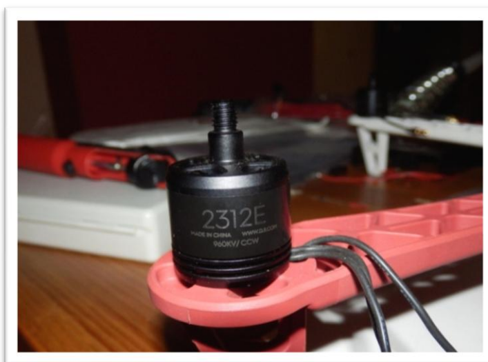
Εικόνα 3.6: Η τοποθέτηση των κινητήρων
