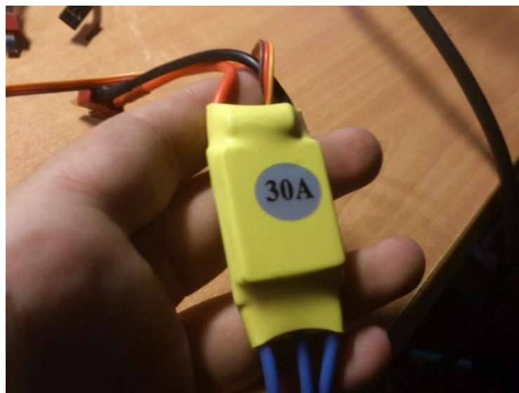
Εικόνα 3.7: Η τοποθέτηση των Esc των 30A
