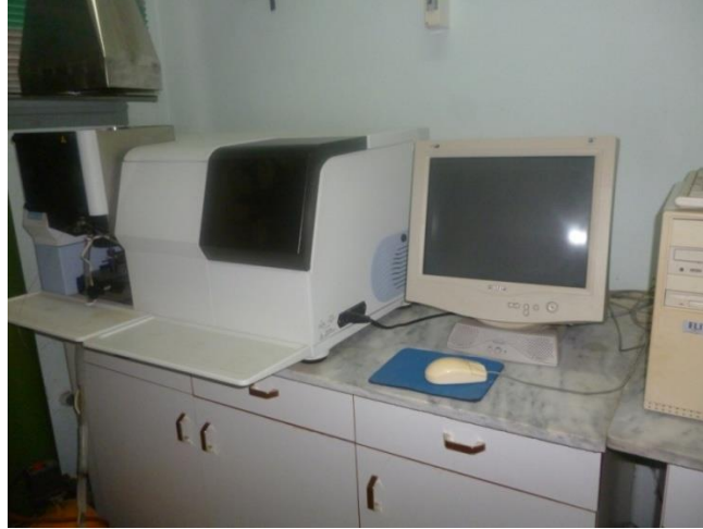
Εικόνα 4: Φασματοφωτόμετρο Ατομικής Απορρόφησης φλόγας PerkinElmer Analyst 300 του Εργαστηρίου Χημείας του Α.Τ.Ε.Ι.Θ.
