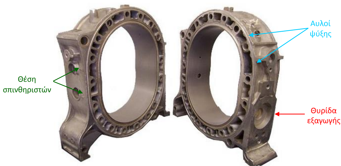
Σχήμα 3: Δομή του στάτορα 27
