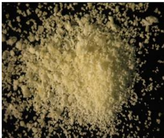
Εικόνα 10: Συνθετική ρητίνη επιγλωδρίνης-πολυαιθυλενιμίνης (Σαρρή, 2011)
