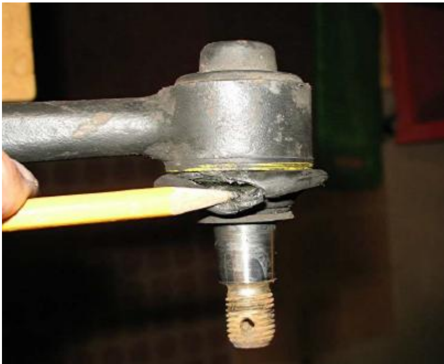
Σχ. 5.17: Κομμένο ελαστικό περίβλημα άρθρωσης .
