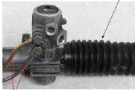
ΠΑΡΟΧΗ ΣΥΜΠΙΕΣΜΕΝΟΥ ΥΓΡΟΥ ΠΡΟΣ ΤΗ ΔΕΞΙΑ – ΑΡΙΣΤΕΡΗ ΠΛΕΥΡΑ ΤΟΥ ΕΜΒΟΛΟΥ ΣΤΟ ΕΣΩΤΕΡΙΚΟ ΤΟΥ ΚΥΛΙΝΔΡΟΥ ΕΡΓΑΣΙΑΣ
