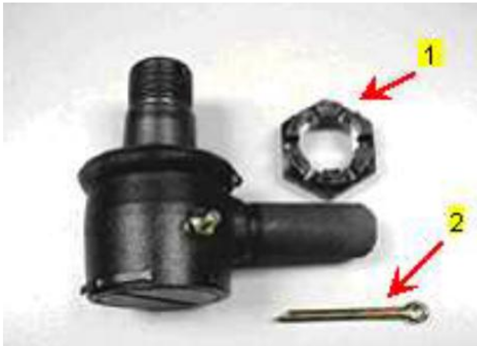
Σχ. 5.18: Άρθρωση με πυργωτό περικόχλιο και ασφαλιστική περόνη.
