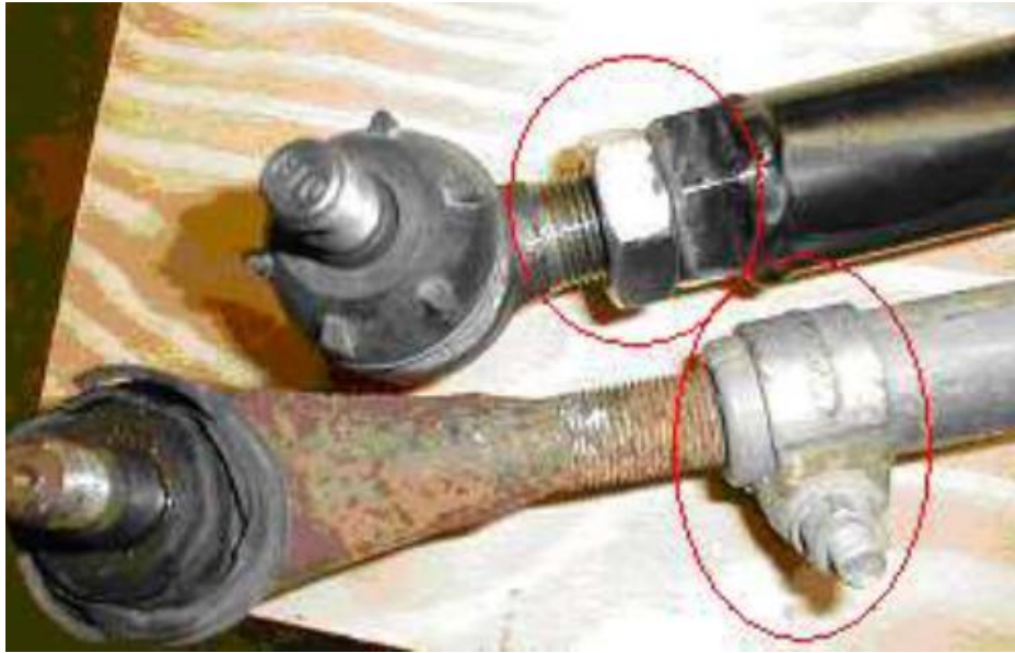
Σχ. 5.16: Σύνδεση ακρόμπαραυ με την μπάρα.
