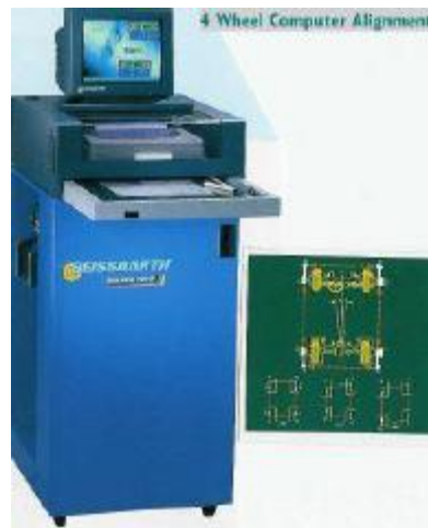
Σχ. 3.8: Δύο τύποι ηλεκτρονικής ευθυγράμμισης: A) στους Bessbarth ML 400 και B) beissbarth ML 3000PC
