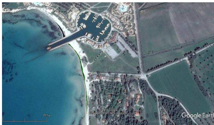
Εικόνα 39: Η μαρίνα της Σάνης σε αεροφωτογραφία του έτους 2014 με εμφανείς τις επιδράσεις στην παραλιακή ζώνη. Πηγή: Google Earth.
