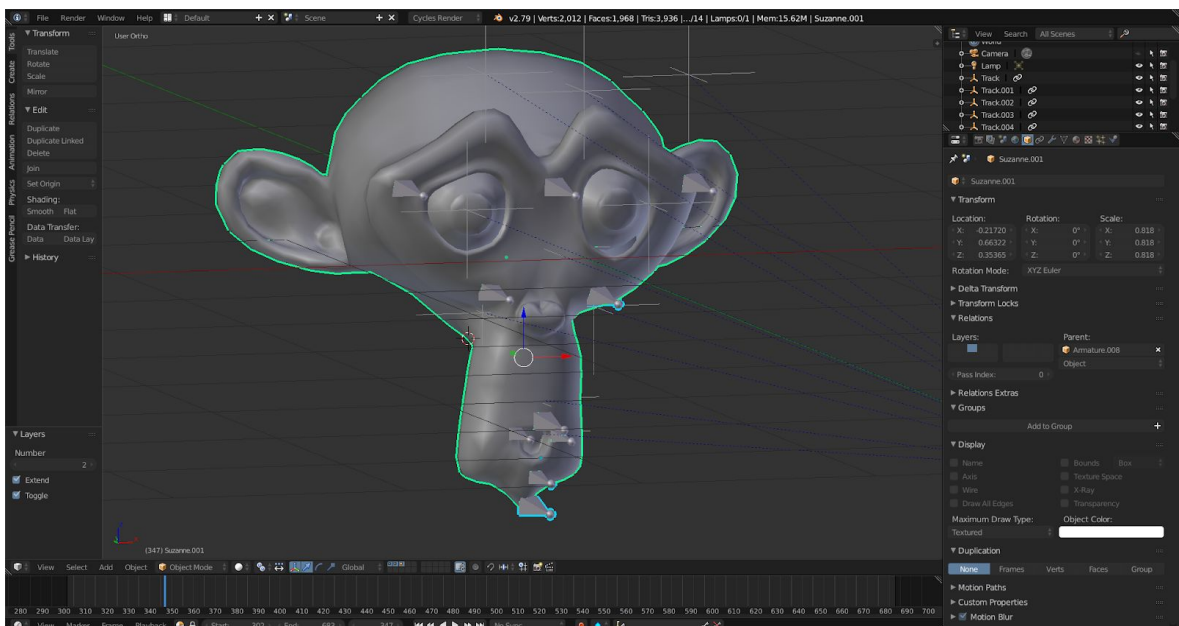
Εικόνα 26. Τα κόκαλα ρυθμίζονται έτσι ώστε να δέχονται μικρότερη επιρροή από τα Empties στα οποία αντιστοιχίζονται. Πλέον η παραμόρφωση του μοντέλου βρίσκεται εντός αποδεκτών ορίων.
