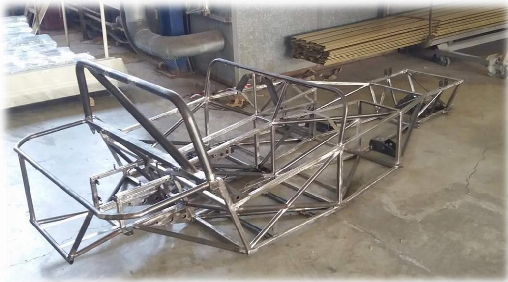
Σχ.3.3.7 Ολοκληρωμένο πλαίσιο πριν την βαφή.
