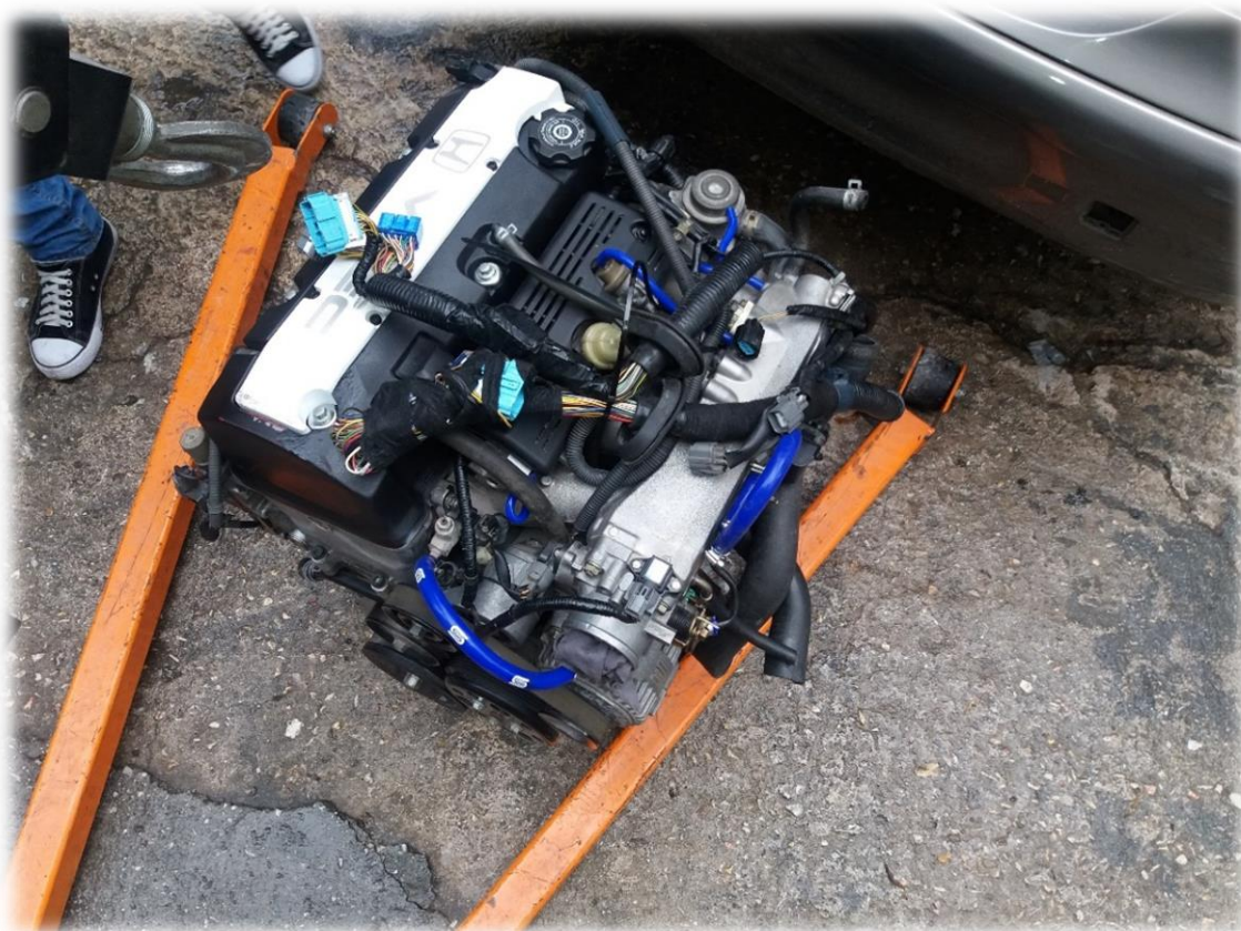
Σχ.1.3.1.1 Ο κινητήρας με το κύριο μέρος της πλεξούδας του.
