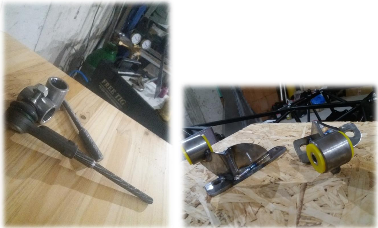
Σχ.4.2.1 “Φωλιές” sinnemplotok αριστερά και κύριες βάσεις διαφορικού πριν την βαφή στα δεξιά.
