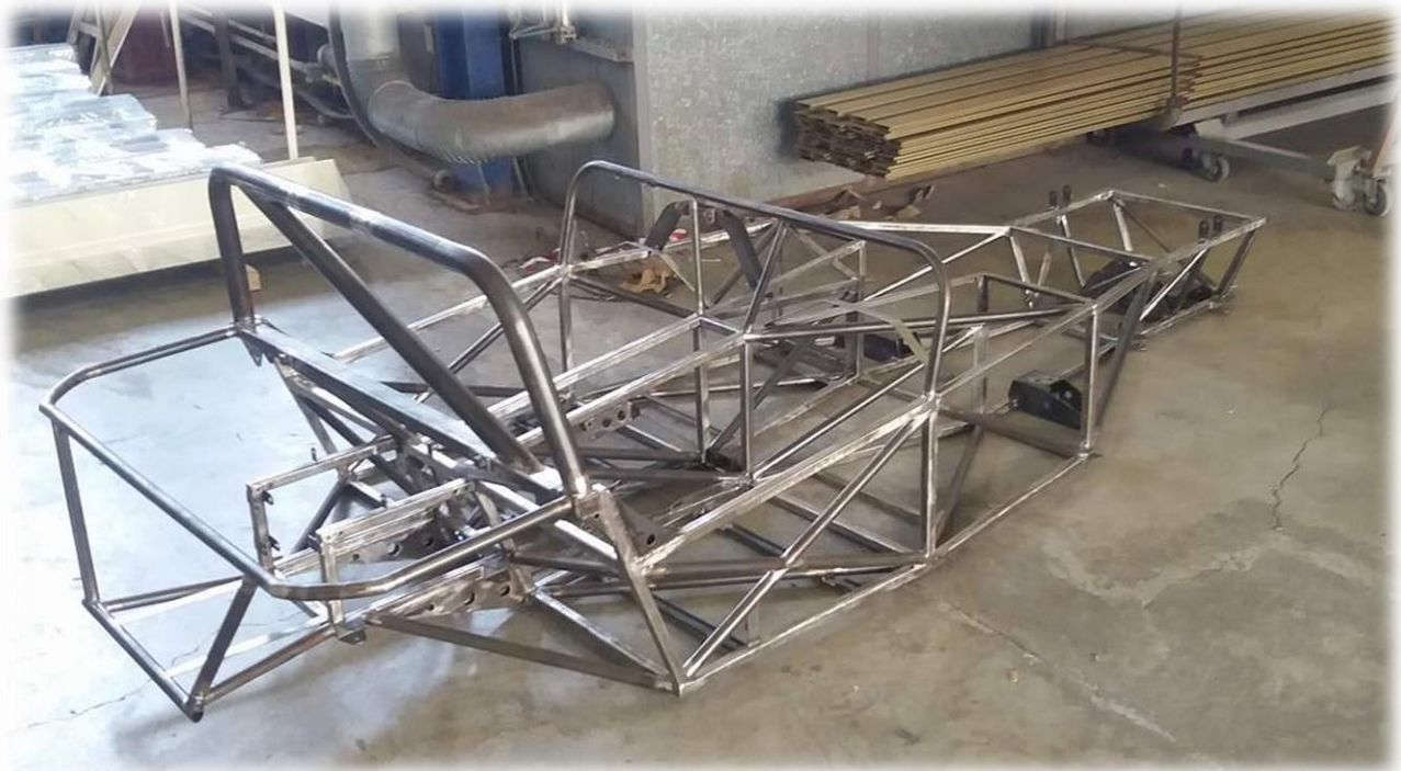
Σχ.3.1.1 Πλαίσιο του οχήματος της εργασίας πριν την βαφή.
