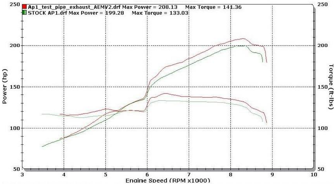
Σχ.1.3.1.2 Καμπύλη ροπής-στροφών και ισχύος- στροφών του κινητήρα Honda F20C.
