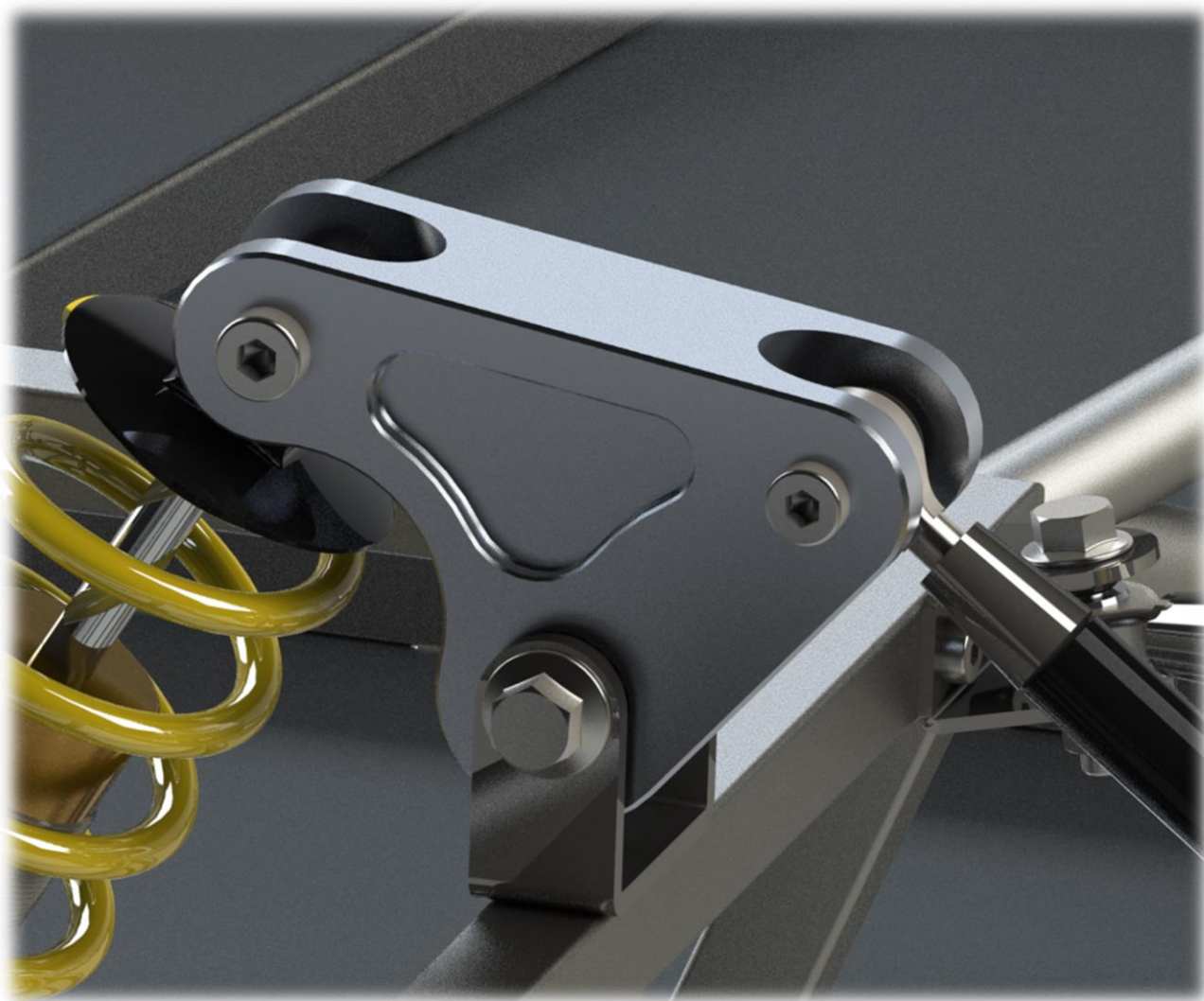
Σχ.2.8.2.1 Βραχίονας με αμορτισέρ και ράβδο ώθησης (Push rod). Φωτορεαλιστικό μοντέλο στο Solidworks.
