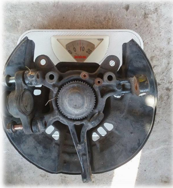
Σχ.1.3.2.1 Ζύγιση εμπρόσθιου ακραζονίου.
