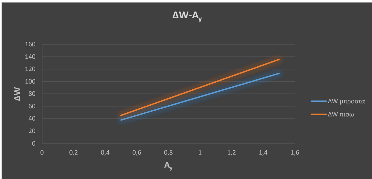
Σχ. 2.7.1 Μεταφορά βάρους αξόνων με εγκάρσια επιτάχυνση.
