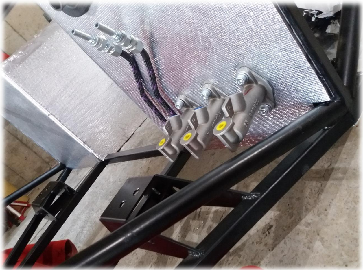
Σχ.4.2 Πρόσθετη θερμομόνωση μαζί με τις γραμμές καυσίμου και τις αντλίες φρένων-συμπλέκτη.
