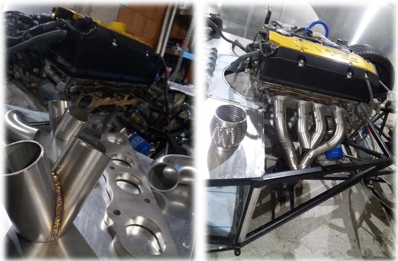
Σχ.4.5.1 Ετοιμασία σωλήνων και χτίσημο πολλαπλής εξαγωγής.
