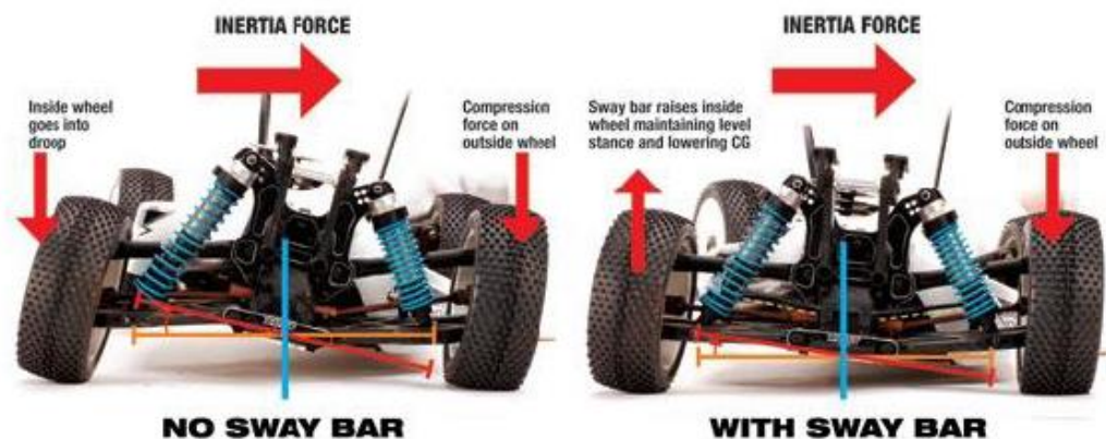
Εικόνα 1.6 : Λειτουργία της αντι-στρεπτικής ράβδου [12].
