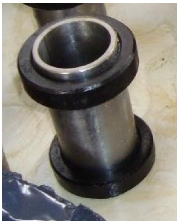
Εικόνα 4.22: Συναρμολογημένη μήτρα νέου τύπου με σταθερούς πλαστικούς σφιγκτήρες – δακτύλιοι.
