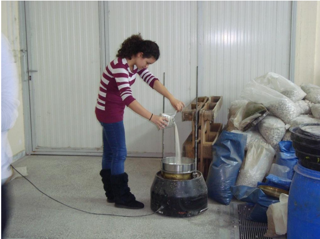
Εικόνα 4.7: Ρήψη της μη διαβαθμισμένης άμμου στο κόσκινο Νο 20.
