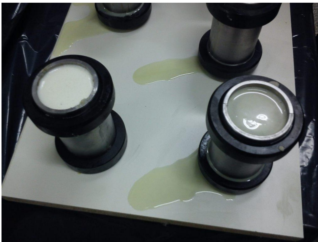
Εικόνα 4.27: Φαινόμενο διαρροής υγρού κατά τη διάρκεια σκλήρυνσης του μίγματος.
