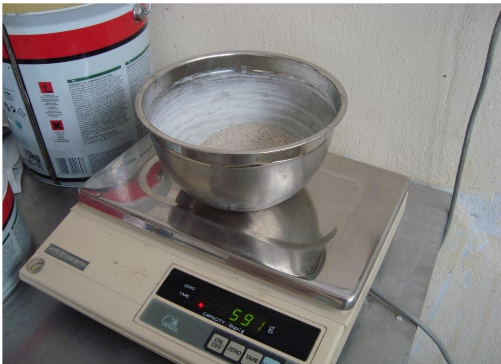
Εικόνα 4.18: Ζύγιση Γαλλικής άμμου σε ζυγαριά ακριβείας πριν τη ρήψη της σε μεταλλικό δοχείο, ώστε να γίνει ανάδευση του μίγματος.
