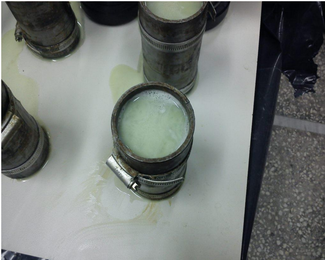
Εικόνα 4.26: Λιμνάζων υγρό στην επιφάνεια του μίγματος αμέσως μετά την ρήξη του υλικού στις μήτρες.
