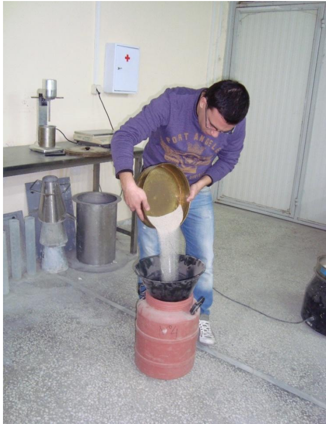
Εικόνα 4.12: Αποθήκευση της κοσκινισμένης άμμου σε πλαστικό δοχείο.
