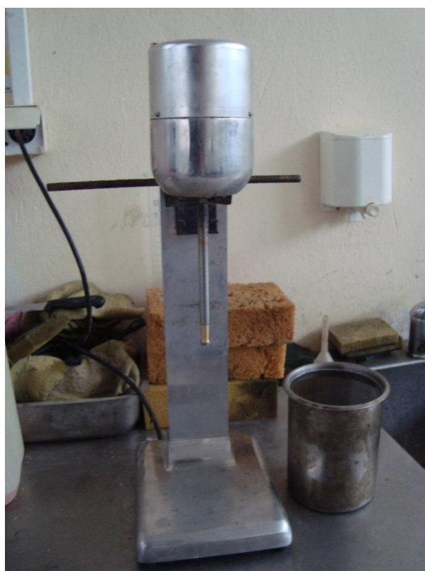
Εικόνα 4.16: Μηχάνημα ανάδευσης πολλών στροφών
