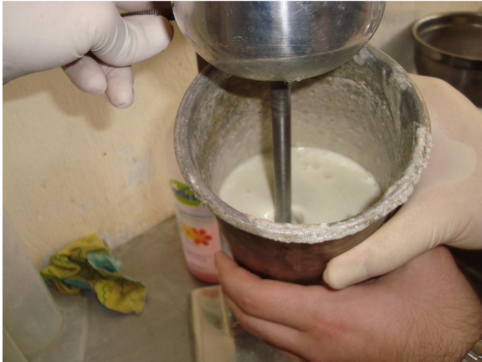
Εικόνα 4.17: Ανάδευση εποξειδικής ρητίνης, σκληρυντή και πόσιμου νερού σε μεταλλικό δοχείο με κατάλληλο μηχάνημα ανάδευσης.
