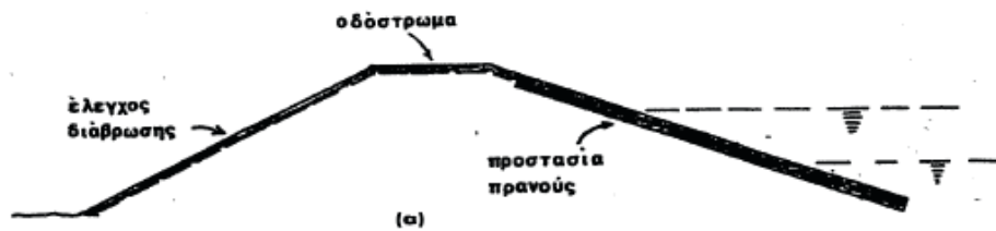
α) Επιστρώσεις - επικαλύψεις με μίγμα εδάφους - τσιμέντου.
