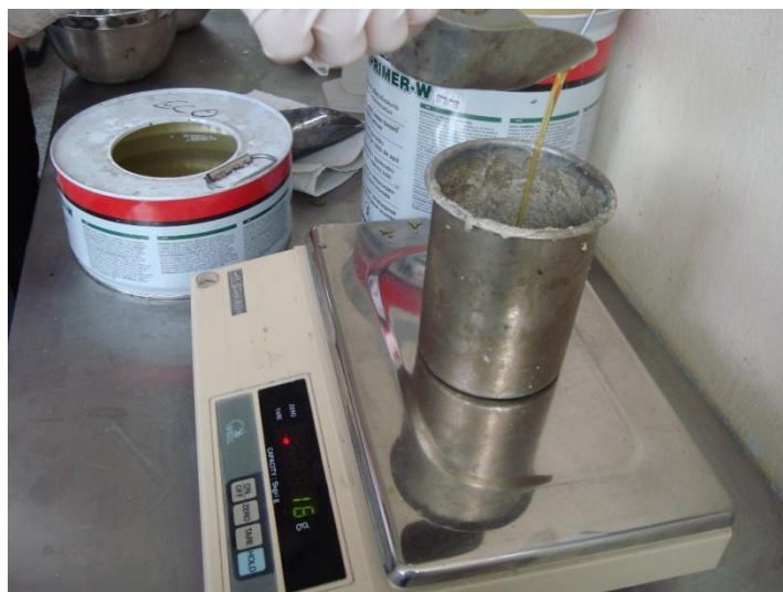
Εικόνα 4.13: Ρήψη εποξειδικής ρητίνης (Συστατικό Α) σε μεταλλικό δοχείο και ζύγιση της σε ζυγαριά ακριβείας.
