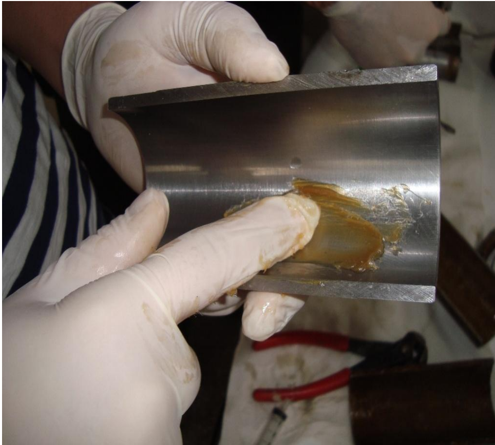
Εικόνα 4.20: Αλοιφή των μητρών με γράσο φορώντας κατάλληλα μέτρα ατομικής προστασίας (χειρουργικά γάντια).
