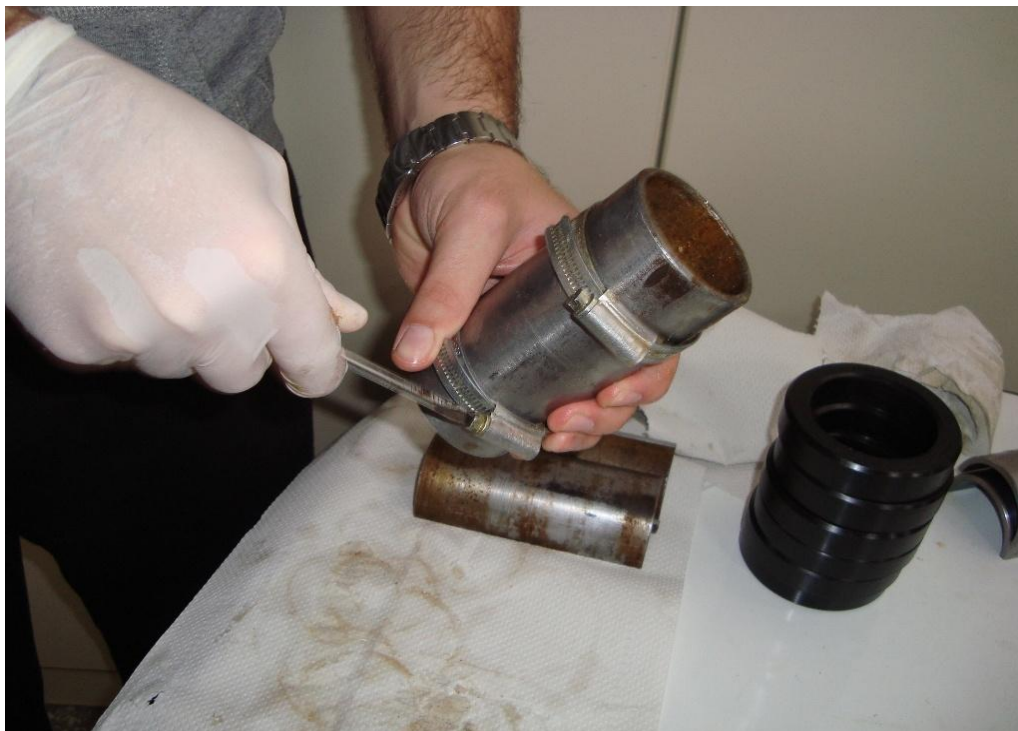
Εικόνα 4.21: Συναρμολόγηση των παλαιού τύπου ανοξείδωτων μητρών και βίδωμα των μεταλλικών σφικτήρων με κατσαβίδι.
