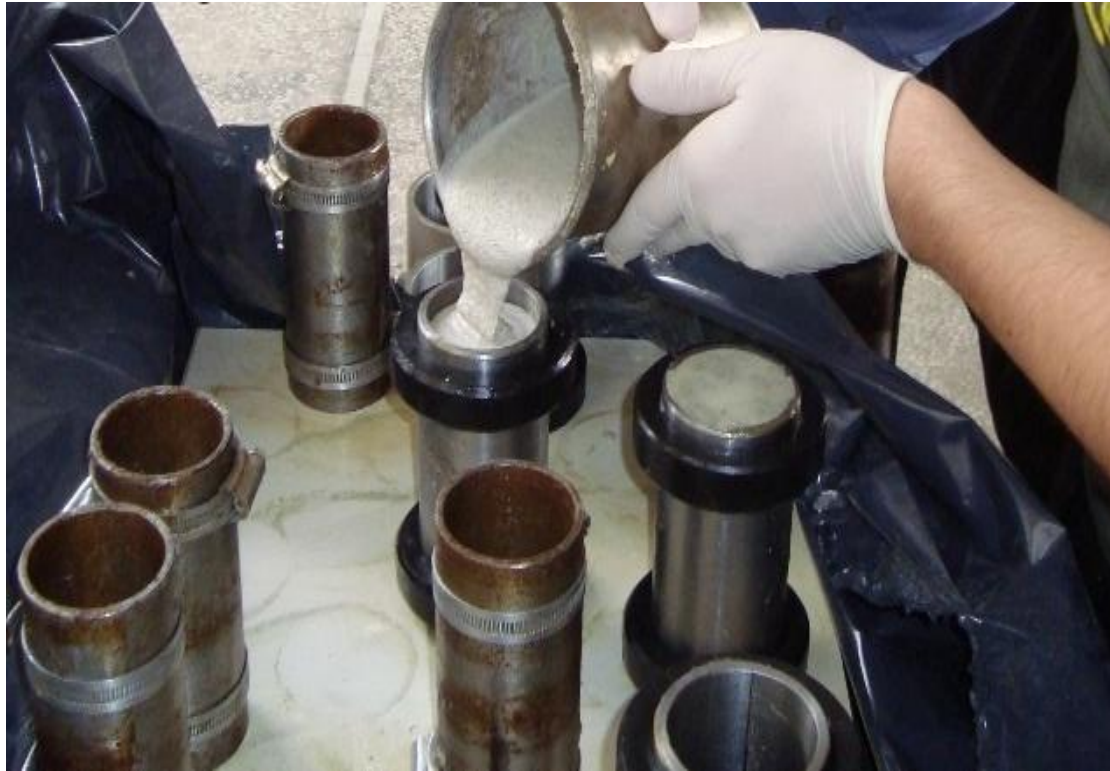
Εικόνα 4.23: Ρίψη του τελικού μίγματος στις συναρμολογημένες μήτρες.
