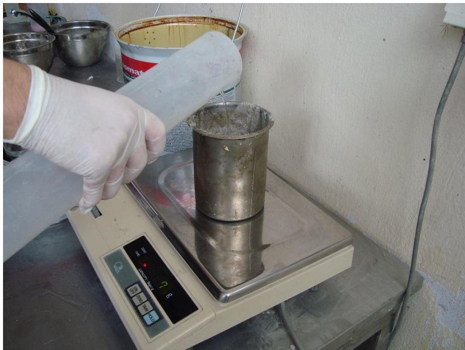
Εικόνα 4.15: Ρήψη πόσιμου νερού από ογκομετρικό κύλινδρο σε μεταλλικό δοχείο και ζύγισή του σε ζυγαριά ακριβείας.
