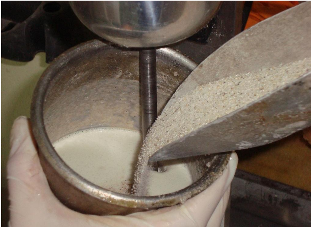
Εικόνα 4.19: Ρήψη Γαλλικής άμμου σε μεταλλικό δοχείο και ανάδευση της με το μίγμα εποξειδικής ρητίνης, σκληρυντή και νερού.
