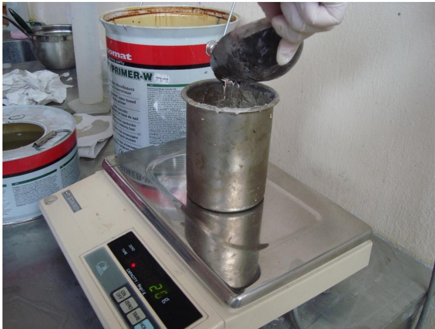
Εικόνα 4.14: Ρήψη σκληρυντή (Συστατικό Β) σε μεταλλικό δοχείο και ζύγισή του σε ζυγαριά ακριβείας.
