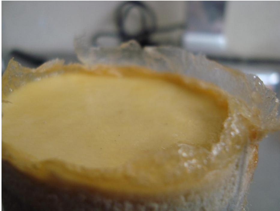
Εικόνα 4.31: Εποξειδική ρητίνη σε στερεά μορφή στην επιφάνεια του δοκιμίου μετά την σκλήρυνση του.
