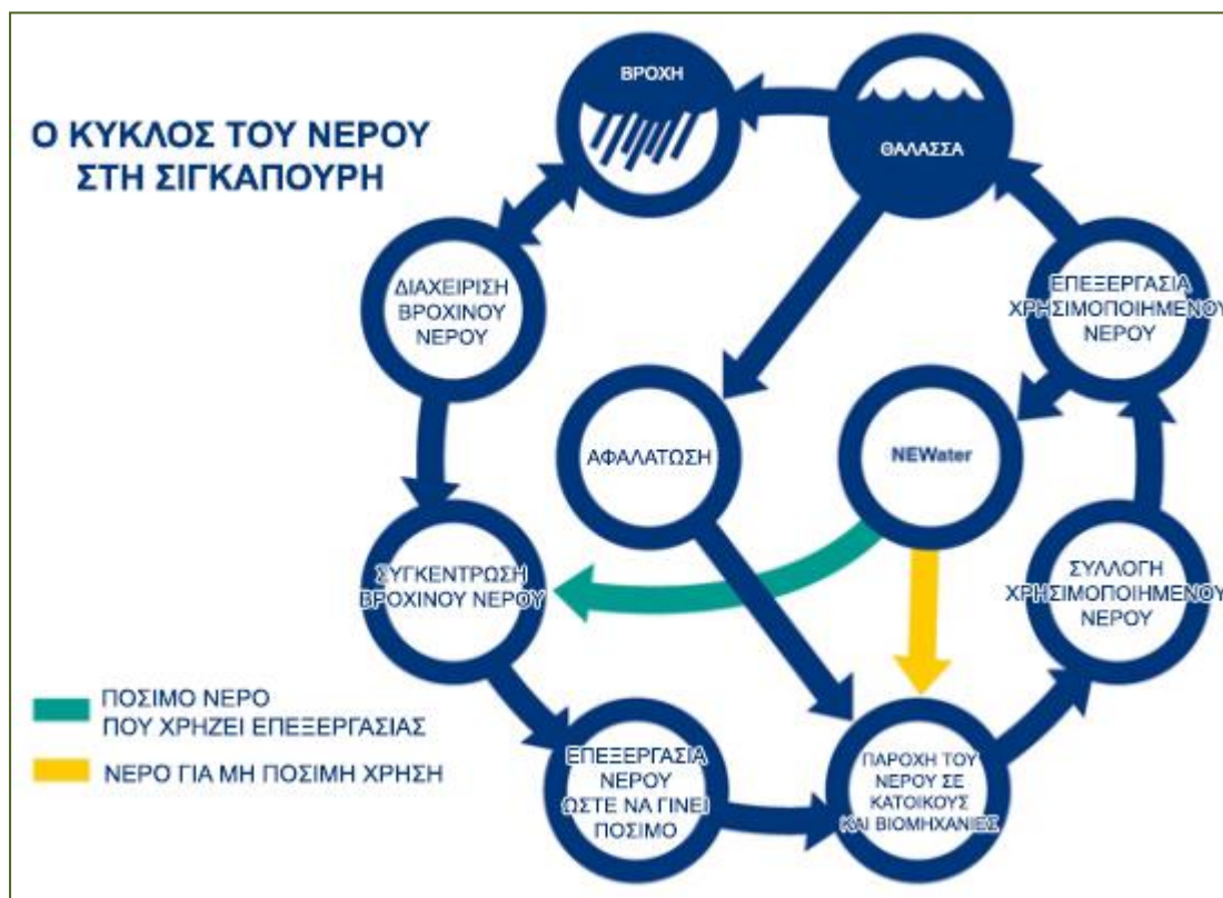
Εικόνα 19: Κύκλος νερού Σιγκαπούρης, (ιδία επεξεργασία από: Xi and Poh (2015) “A Novel Integrated Decision Support Tool for Sustainable Water Resources Management in Singapore”)
