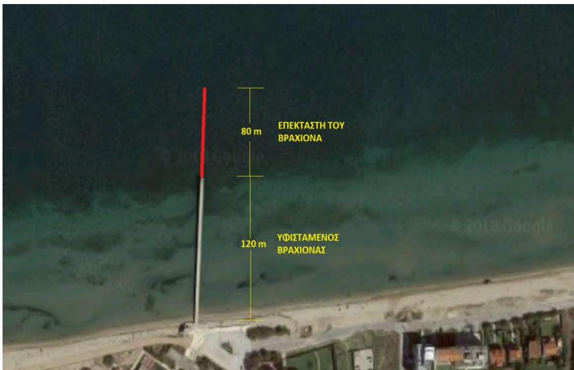
Εικόνα 89 : Επέκταση-επιμήκυνση υφιστάμενου βραχίονα στη δυτική πλευρά του αλιευτικού καταφυγίου (επεξεργασία από εικόνα του Google Earth 20-10-2018)
