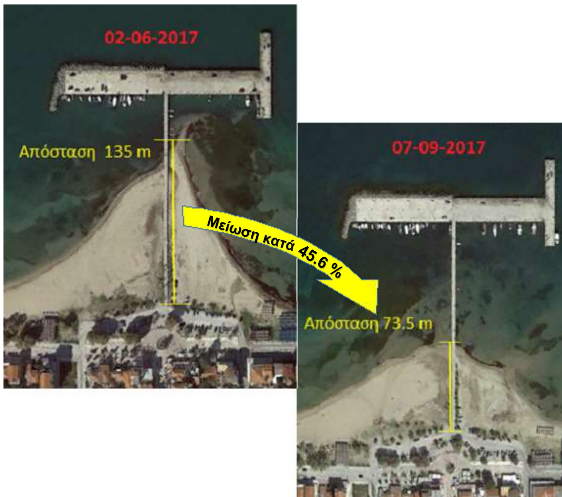
Εικόνα 35 : Μήκος του φαινομένου salient πριν και μετά την εξάμμωση (πηγή Google Earth)
