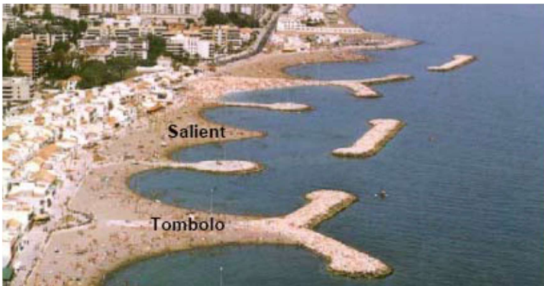
Εικόνα 6 : Σχηματισμοί Tombolo και Salient που εμφανίστηκαν στην τεχνητή παραλία του Pedregalejo στη Μάλαγα της Ισπανίας. (Κουτσουβέλας, 2010)
