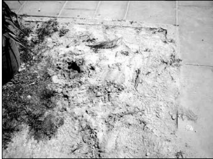
Σχήμα 2.15 Δημιουργία κώνου άμμου σε θέση ρευστοποίησης στη Λευκάδα (Παπαθανασίου κ.α., 2004)
