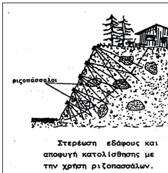
Σχήμα 3.7 Βελτίωση εδάφους με χρήση ριζοπασσάλων
