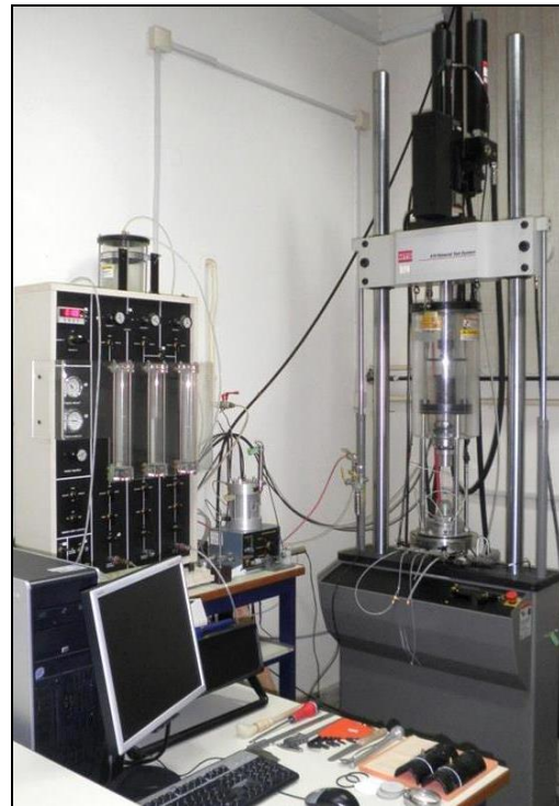
Σχήμα 2.26 Τριαξονική συσκευή ανακυκλικής φόρτισης (Αριστοτέλειο Πανεπιστήμιο Θεσσαλονίκης, Βράννα, 2016).
