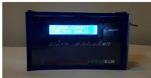
Εικόνα 6.3 Η ένδειξη στην οθόνη της συσκευής «PLEASE, CONNECT THE Y/B CABLES», στα ελληνικά «ΠΑΡΑΚΑΛΩ, ΣΥΝΔΕΣΤΕ ΤΟ ΚΙΤΡΙΝΟ ΚΑΙ ΤΟ ΜΑΥΡΟ ΚΑΛΩΔΙΟ»
