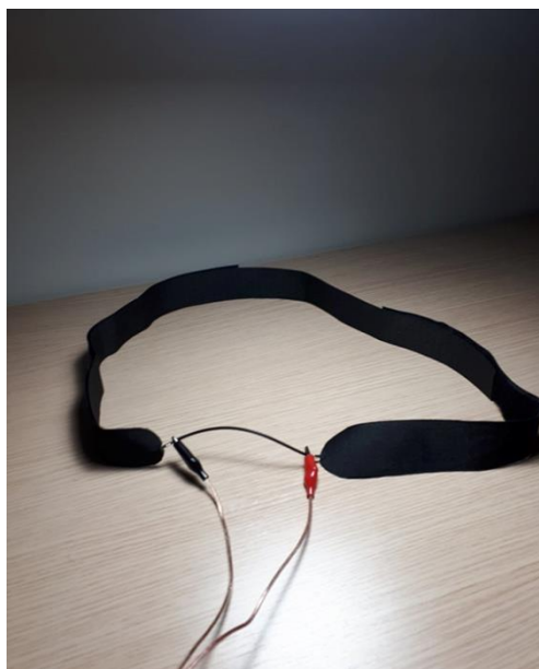
Εικόνα 6.2 Πειραματική συσκευή biofeedback για την εκμάθηση της διαφραγματικής αναπνοής. Η ζώνη της συσκευής και ο αισθητήρας διάτασης.
