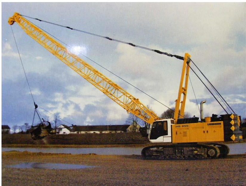
Σχ.2.3 Εκσκαφέας με συρόμενο κάδο της Liebherr.
