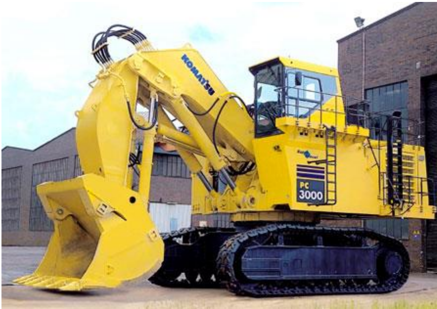
Σχ.2.1 Εκσκαφέας με μετωπικό κάδο της Komatsu.
