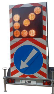
Εικόνα 5.8: Κινητή μονάδα σήμανσης
