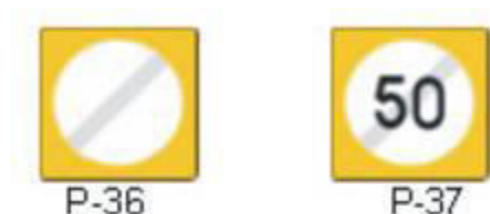
Εικόνα 5.3: Σήμανση Ζώνης Αποκατάστασης Κυκλοφορίας σε περιοχή οδικών έργων
