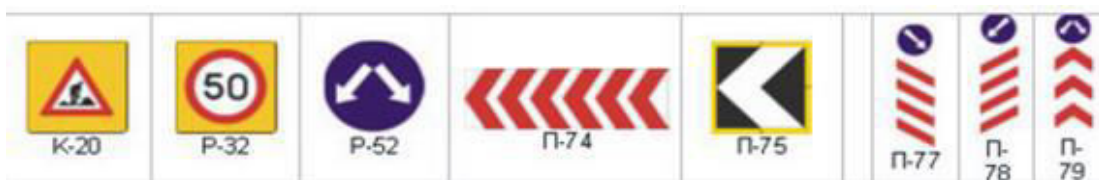
Εικόνα 5.2: Σήμανση Ζώνης Συναρμογής Εισόδου σε περιοχή οδικών έργων
