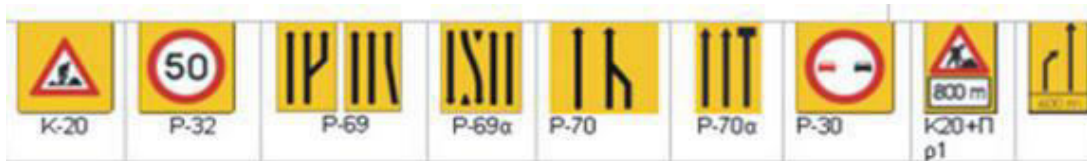
Εικόνα 5.1: Σήμανση Ζώνης Προειδοποίησης σε περιοχή οδικών έργων
