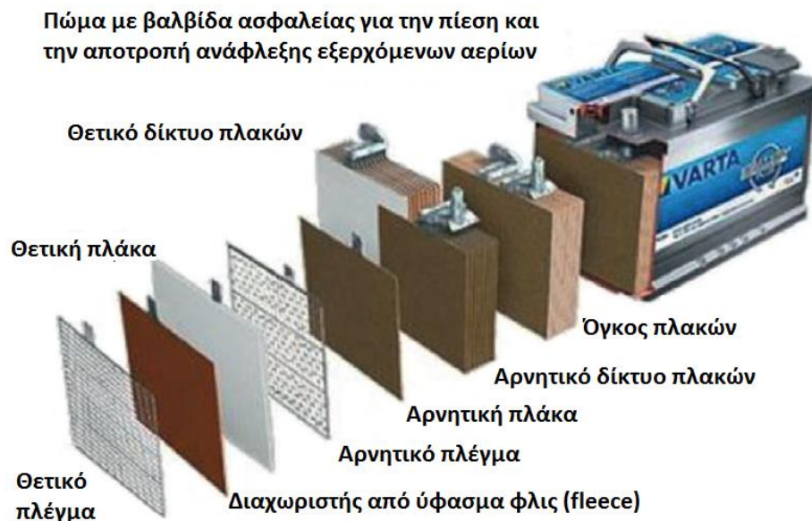
Εικόνα 6 – Ανεπτυγμένη οπτική της πρισματικής εκδοχής μιας μπαταρίας Μολύβδου-Οξέος 12V
