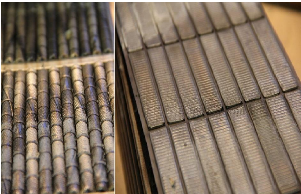
Εικόνα 13 – Διάτρητοι κύλινδροι θετικό δίκτυο (αριστερά). Διάτρητες ατσάλινες πλάκες αρνητικού δικτύου (δεξιά).
