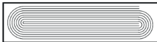
Εικόνα 25 – Σχηματική απεικόνιση τυλίγματος κελιού τζελ
