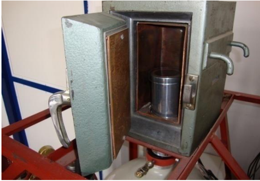
Εικόνα 3: Το πάνω μέρος του κρυοστάτη μέσα στην θωράκιση του ανιχνευτή.
