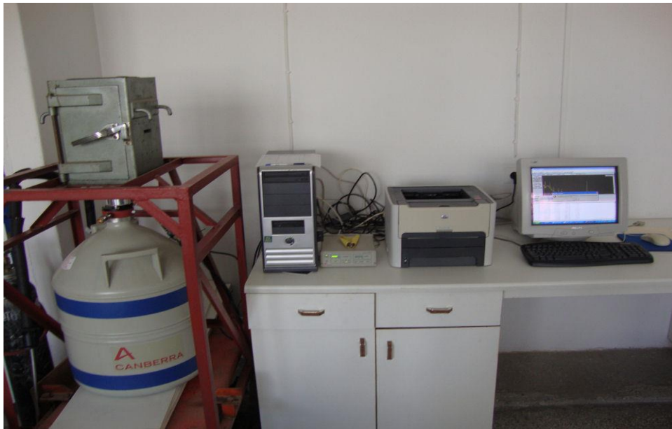
Εικόνα 2: Η ανιχνευτική διάταξη HPGe της εργασίας.
