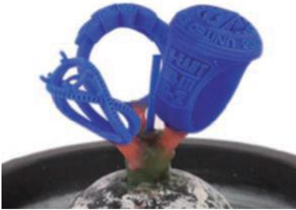
17.Χύτευση κοσμήματος(Lost wax application) – κοσμηματοποιία)
