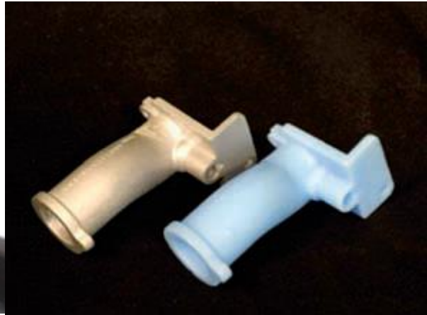
18.Χυτεύσιμο κέρινο μοντέλο και τελικό χυτό μεταλλικό εξάρτημα
