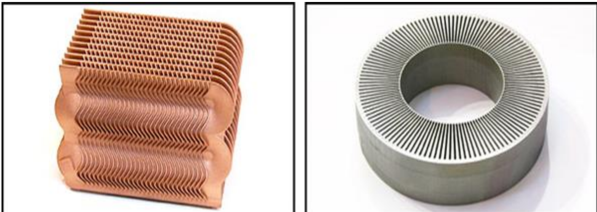
7. Εκτυπωμένα σε τρισδιάστατο εκτυπωτή μεταλλικά κομμάτια με τη μέθοδο powder bed fusion.
