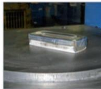
16. Hydroforming – Παραγωγή περιορισμένου αριθμού πρεσαριστών μεταλλικών τεμαχίων με καλούπι τυπωμένο σε 3D Printer
