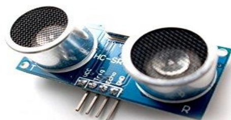
Εικόνα 20 : Αισθητήριο απόστασης HC-SR04.
