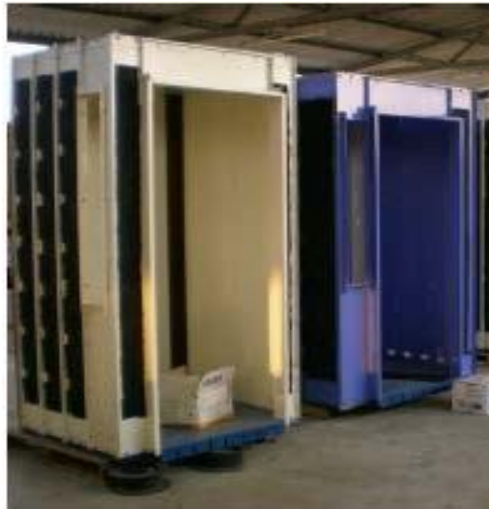
Σχήμα 3.2 Ενδεικτικός θάλαμος ανελκυστήρα
