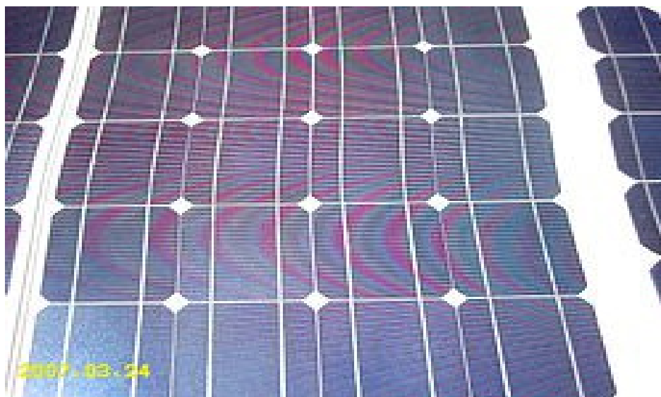
Φωτοβολταϊκά από μονοκρυσταλλικό πυρίτιο
