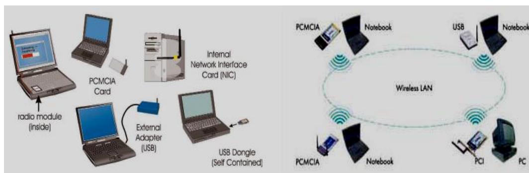
ΕΙΚΟΝΑ 3: ΣΤΑΘΜΟΙ ΑΣΥΡΜΑΤΩΝ ΔΙΚΤΥΩΝ
