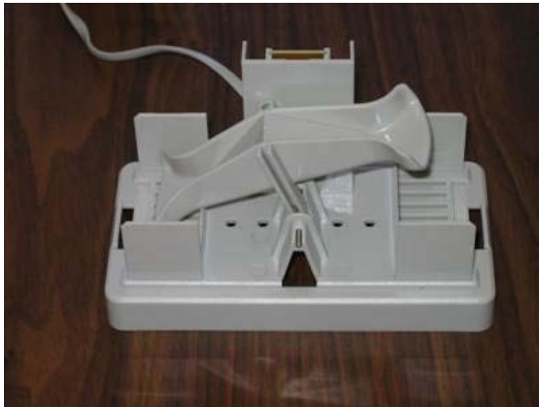
Σχήμα 2.7 Εσωτερική άποψη του βροχόμετρου
