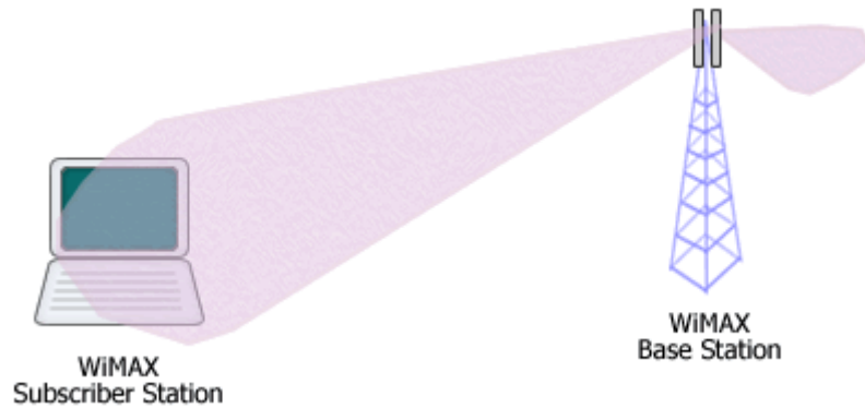
Σχήμα 4.8 WiMAX σταθμός βάσης με χρήση AAS beamforming συστήματος [3]
