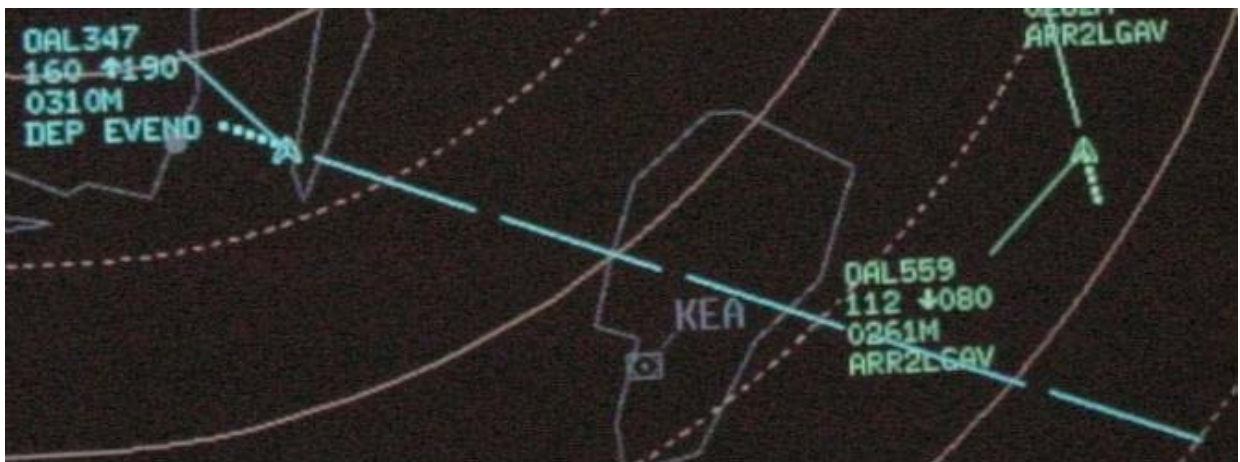
Εικόνα 4: Άνυσμα ταχύτητας στόχου πεντάλεπτου. Τα ενδιάμεσα κενά είναι απόσταση ίση με μια ανανέωση της εικόνας (10 δευτερόλεπτα στον έλεγχο περιοχής, 6 στην προσέγγιση).
