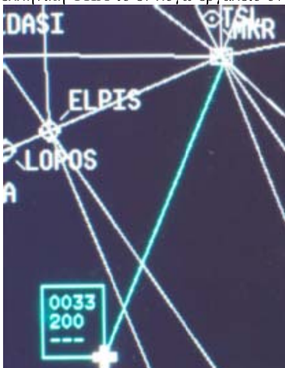
Εικόνα 7: Εργαλείο αποστασιομέτρησης (GCL) Στην πρώτη γραμμή φαίνεται η απόσταση και στη δεύτερη η διόπτευση.
