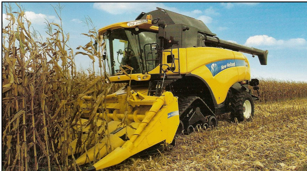
Σχ. 1.2 Σύγχρονη θεριζοαλωνιστική μηχανή κατά τη διάρκεια θερισμού καλαμποκιού.
