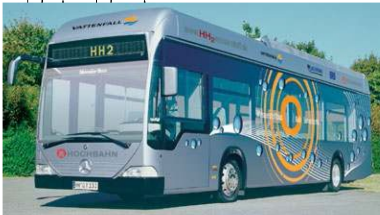
Σχήμα 4.1.6: Αστικό επιβατικό λεωφορείο με κυψέλες καυσίμου υδρογόνου (τέθηκε για πρώτη φορά σε κυκλοφορία το 2006 στην πόλη του Αμβούργου στη Γερμανία).
