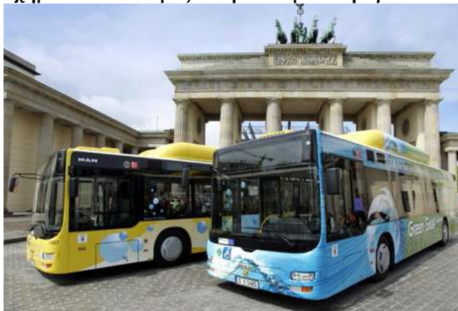
Σχήμα 4.2.7: Αστικά Επιβατικά λεωφορεία της εταιρίας MAN κινούμενα με MEK υδρογόνου, τα οποία κυκλοφόρησαν τον Ιούνιο του 2006 στο Βερολίνο της Γερμανίας, ως μέρος του ευρωπαϊκού προγράμματος
