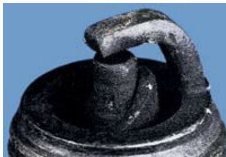
Εικόνα 8.12.12: Αναφλεκτήρας με θραύση της αιχμής του μονωτή.
