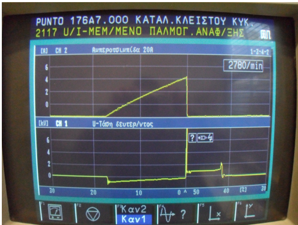
Εικόνα 10.3.14: Αναλυτική μορφή της έντασης του ρεύματος που διαρρέει το πρωτεύον μεμονωμένο στις 2500 rpm.
