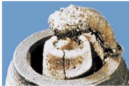
Εικόνα 8.12.8: Αναφλεκτήρας με τήξη κεντρικού ηλεκτροδίου.
