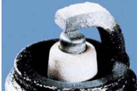
Εικόνα 8.12.1: Φυσιολογική κατάσταση αναφλεκτήρα.
