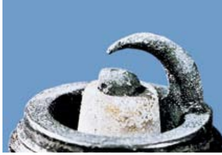
Εικόνα 8.12.11: Αναφλεκτήρας με μεγάλη φθορά στο κεντρικό ηλεκτρόδιο.
