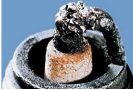
Εικόνα 8.12.9: Αναφλεκτήρας με μερικώς τηγμένα ηλεκτρόδια.
