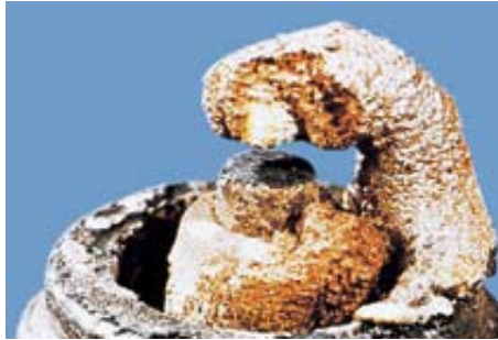
Εικόνα 8.12.6: Αναφλεκτήρας με σχηματισμό καπνιάς.
