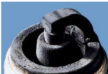
Εικόνα 8.12.2: Αναφλεκτήρας με επικαθίσεις άνθρακα.
