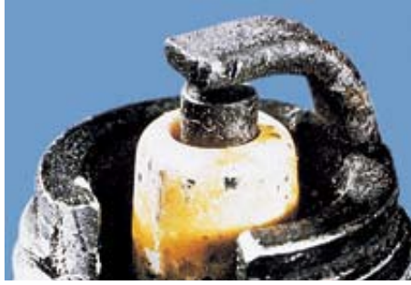
Εικόνα 8.12.4: Αναφλεκτήρας με επικαθίσεις μολύβδου.
