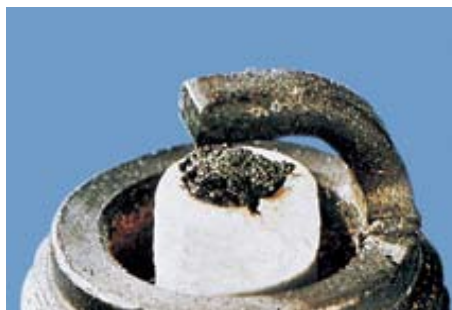
Εικόνα 8.12.7: Αναφλεκτήρας με μερική τήξη του κεντρικού ηλεκτροδίου.
