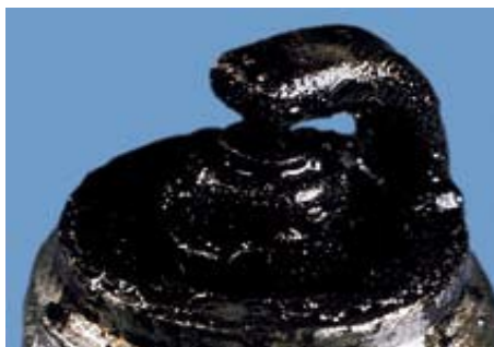
Εικόνα 8.12.3: Αναφλεκτήρας με επικαθίσεις λαδιού.
