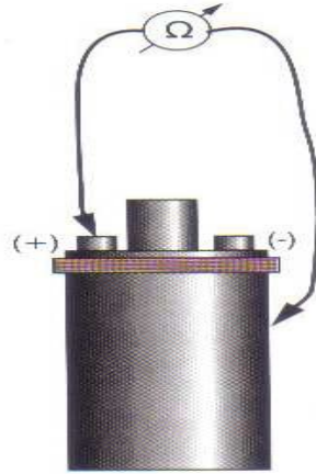
Εικόνα 7.6.2: Έλεγχος της μόνωσης του πρωτεύοντος τυλίγματος.
