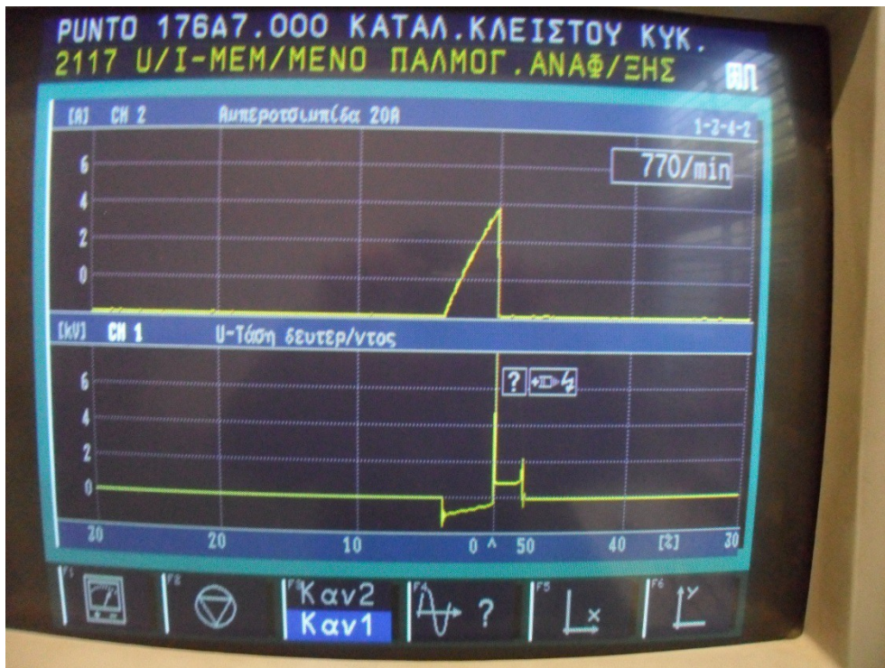
Εικόνα 10.3.13: Αναλυτική μορφή της έντασης του ρεύματος που διαρρέει το πρωτεύον μεμονωμένο στο ρελαντί.
