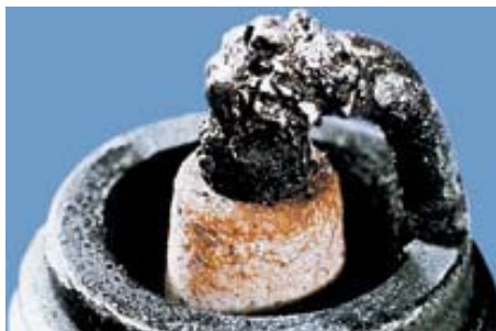
Εικόνα 8.12.10: Αναφλεκτήρας με μεγάλη φθορά κεντρικού ηλεκτροδίου.
