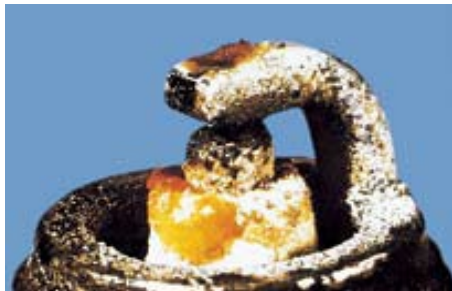
Εικόνα 8.12.5: Αναφλεκτήρας με μεγάλες επικαθίσεις μολύβδου.
