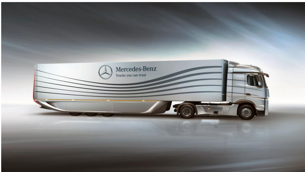
Ημιρυμουλκούμενη μονάδα με ολοκληρωμένα αεροδυναμικά καλύμματα.
