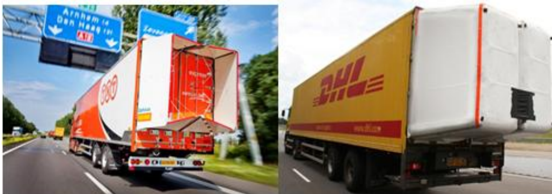
Αναδιπλούμενα (αριστερά) και φουσκωτά (δεξιά) πτερύγια.
