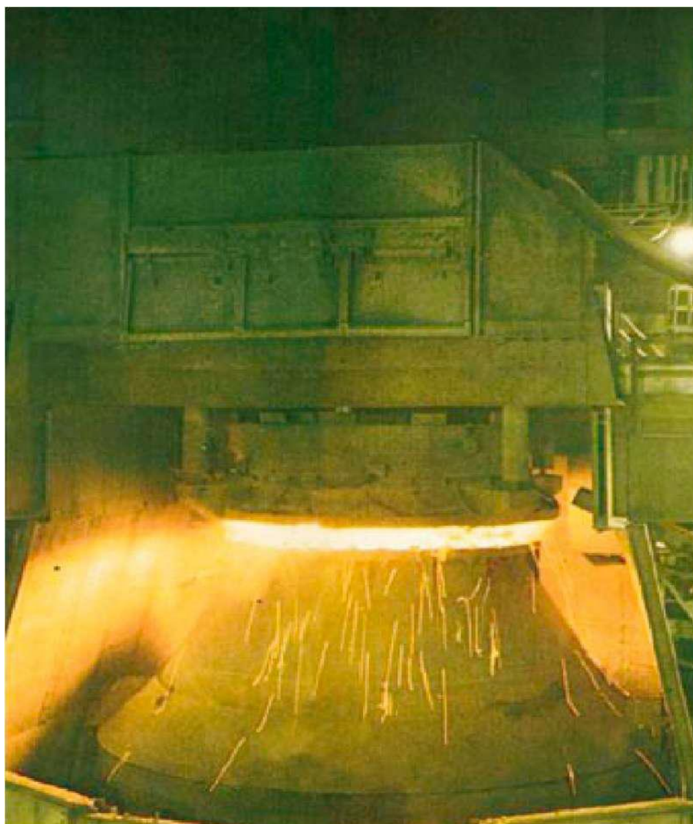
Σχήμα 1.3 Η κορυφή ενός βασικού μετατροπέα παραγωγής χάλυβα με τη μέθοδο οξυγόνου
