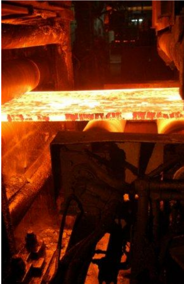
Σχήμα 1.6 Παραγωγή λαμαρίνας με έλαση εν θερμώ
