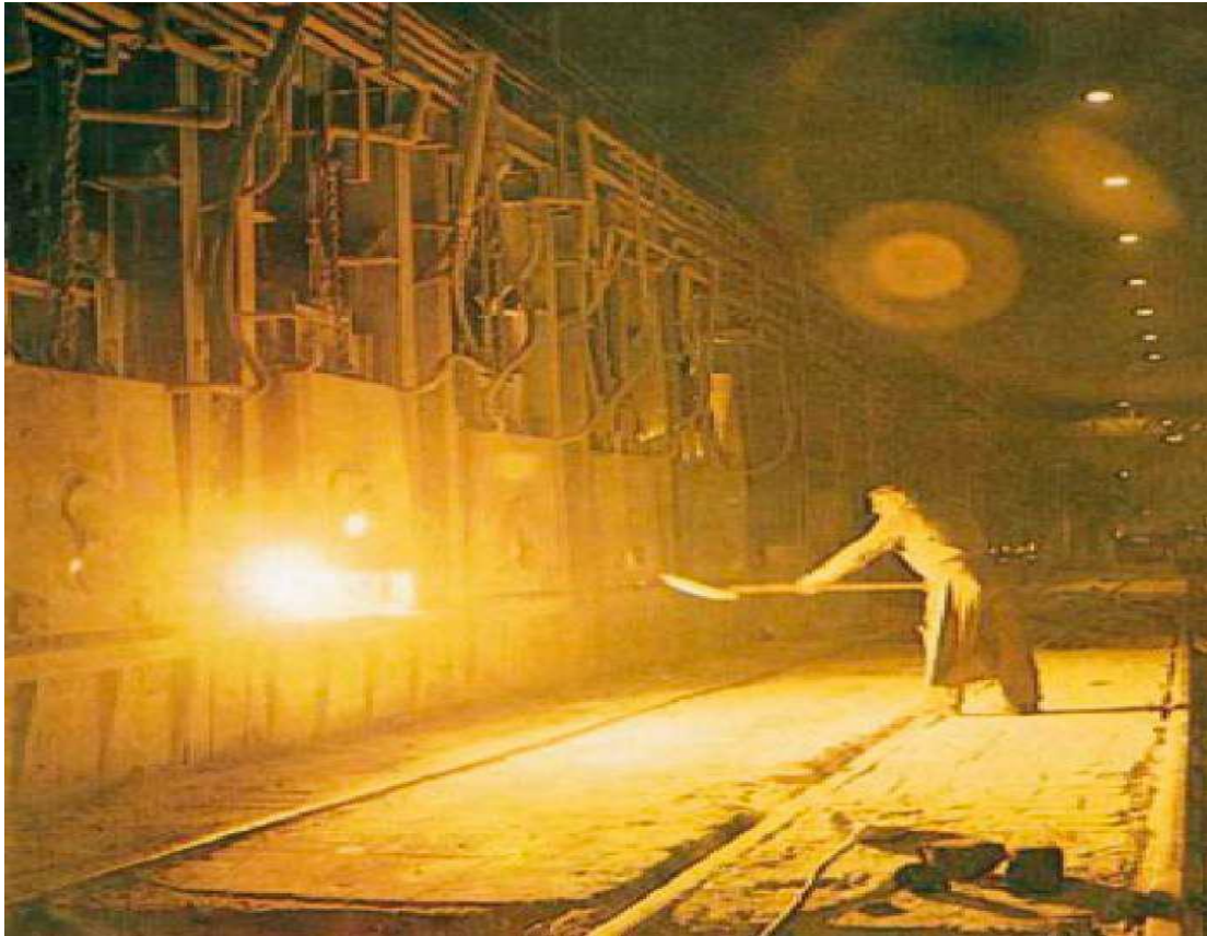
Σχήμα 1.2 Φούρνος ανοικτής εστίας παραγωγής χάλυβα (Μέθοδος Siemens-Martin, 1857)
