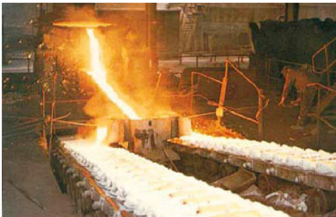
Σχήμα 1.5 Συνεχής χύτευση χάλυβα σε ράβδους
