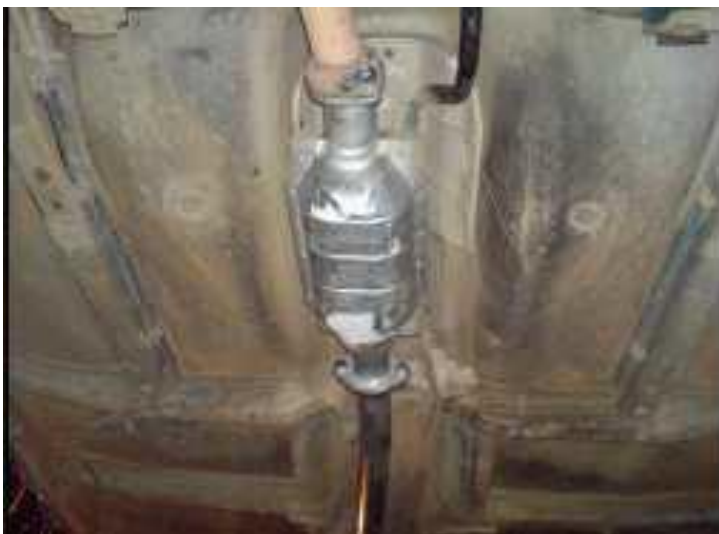
Σχήμα 5.1. Θέση του καταλύτη στο σύστημα εξαγωγής κινητήρα [6].
