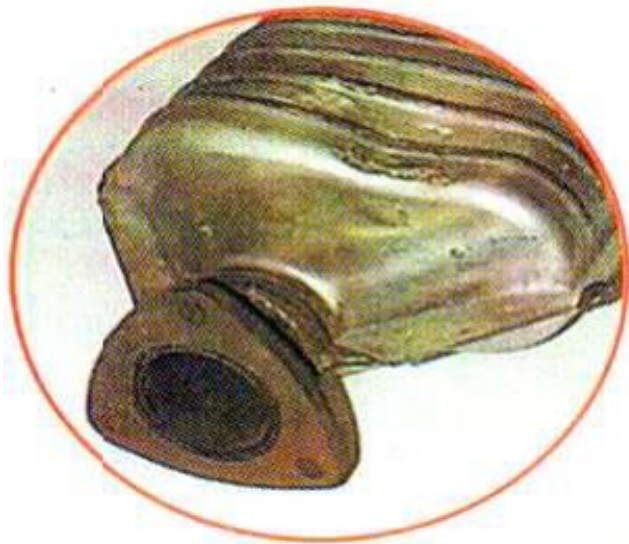
Σχήμα 6.2. Εξωτερική ζημία σε τριοδικό καταλύτη [6].
