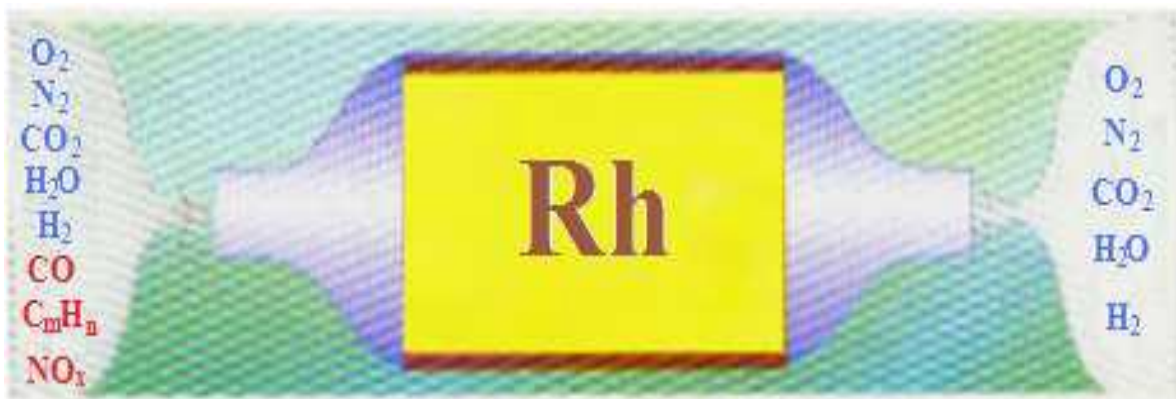
Σχήμα 4.2. Αντιδράσεις αναγωγικού καταλύτη [6].
