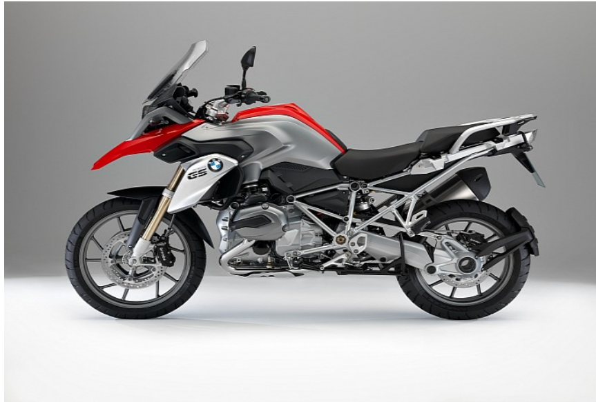
Εικόνα 16: BMW R1200GS '13 η οποία διαθέτει ημι – ενεργητική ανάρτηση (Πηγή: http://www.autoevolution.com/news-g-image/2013-bmw-r-1200-gs-looks-awesome-photo-gallery/88156.html#sjmp )
