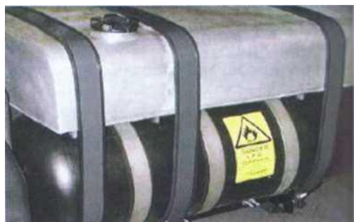
Δεξαμενή Diesel επάνω και LPG κάτω. Χωρητικότητας 350Lt
