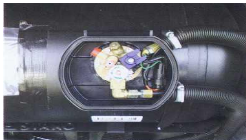
Πολυβαλβίδα και περικάλυμμα Δεξαμενής LPG
