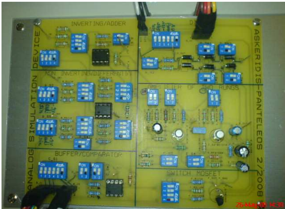
ΒΑΣΙΚΗ ΠΛΑΚΕΤΑ ΟΠΟΥ ΓΙΝΟΝΤΑΙ ΟΛΕΣ ΟΙ ΕΦΑΡΜΟΓΕΣ ΤΩΝ ΚΥΚΛΩΜΑΤΩΝ
