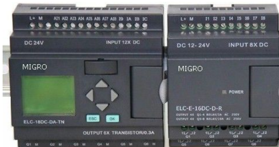
Σχήμα 35: Στο κάτω μέρος του PLC φαίνονται οι εξόδοι (Outputs)
