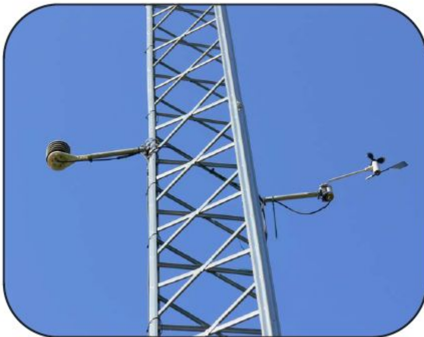
Σχήμα 16: Στον πύργο αυτόν, ύψους 20 μ., βρίσκονται αισθητήρες θερμοκρασίας και αέρα, στον υπό έρευνα αμπελώνα.
