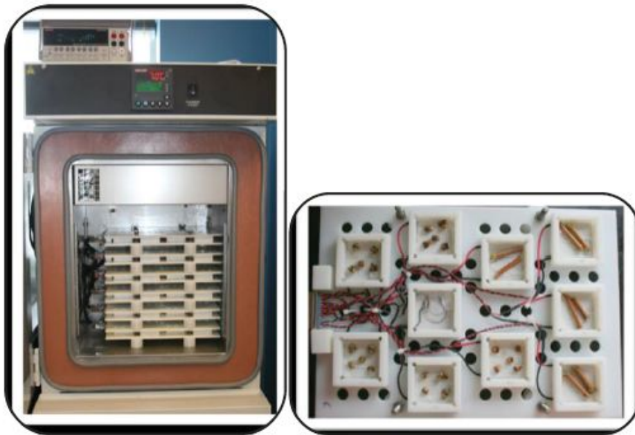
Σχήμα 18: Σύστημα διαφορικής θερμικής ανάλυσης με προγραμματιζόμενο χώρο ψύξης και δίσκος δειγμάτων.
