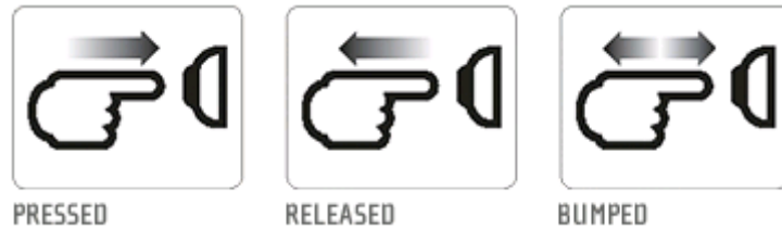
Σχήμα-23. Αρχή λειτουργίας αισθητήρας Αφής
